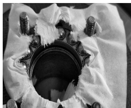
Рис. 2.10. Загальний вигляд етапів розриву серветок при дослідженні на продавлювання: а – задрукована серветка до розриву;
