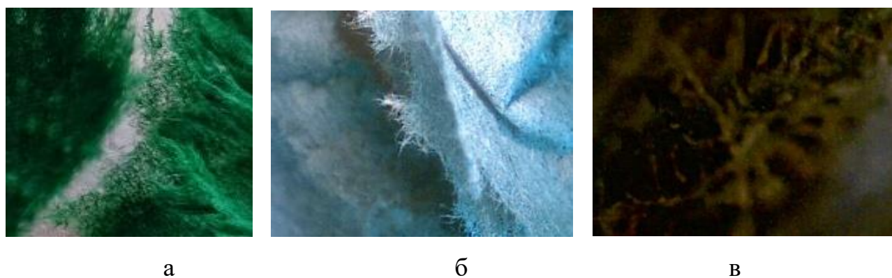
Рис. 4.9. Фотографії оптичної мікроскопії задрукованої цифровим (ink-jet) тришарової серветки з тисненням після продавлювання: збільшення (а – 10х; б – 60х; в – 200х)
