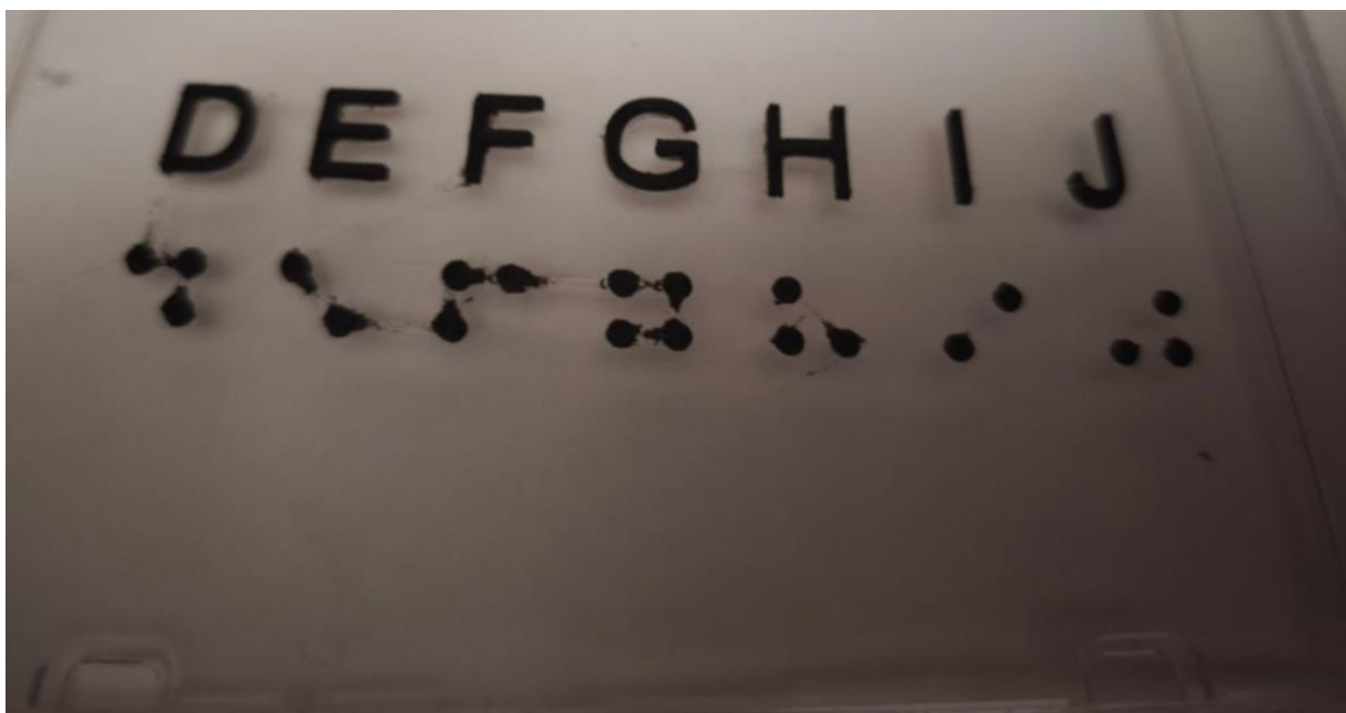
Рис. 4.5.6. Результат 3D-друку PLA-пластиком на прозорій гладкій пластмасовій основі
