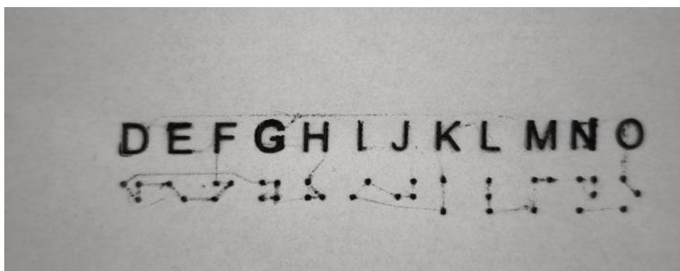
Рис. 4.5.1. Результат 3D-друку PLA-пластиком на офісному папері \sim 70 г/м 2 (фактура текстурована)
