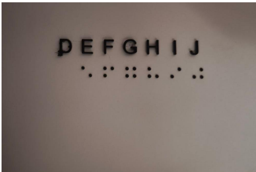
Рис. 4.5.4. Результат 3D-друку PLA-пластиком на папері \sim 130 г/м 2 (фактура текстурована)
