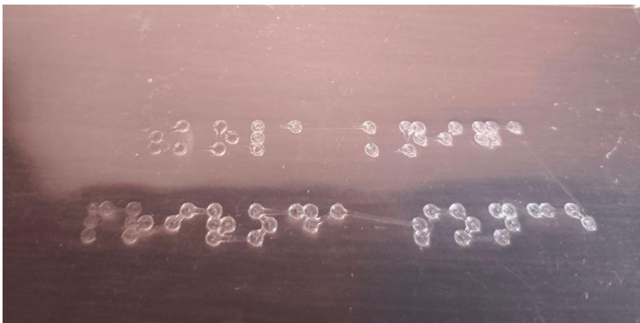
Рис. 4.5.10. Результат 3D-друку PLA-пластиком на прозорому ПВХ-матеріалі
