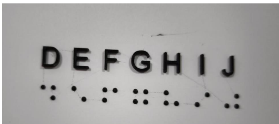
Рис. 4.5.3. Результат 3D-друку PLA-пластиком на папері \sim 150 г/м 2 (фактура гладка)
