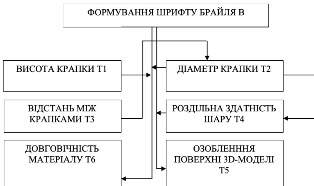
Рис. 3.3.2. Багаторівнева модель факторів процесів виробництва, які впливають на якість формування шрифту Брайля.
