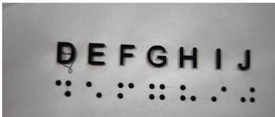
Рис. 4.5.2. Результат 3D-друку PLA-пластиком на папері \sim 80 г/м 2
