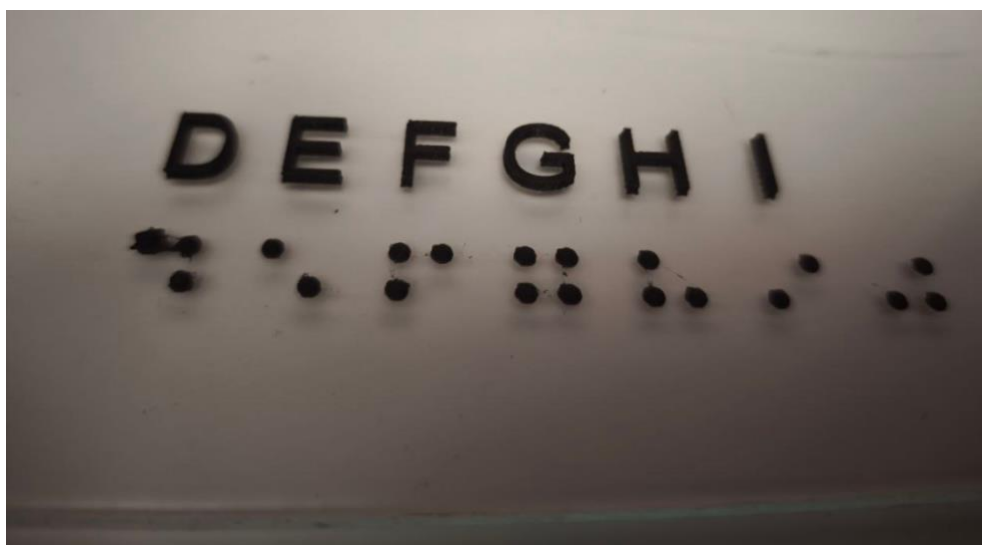
Рис. 4.5.7. Результат 3D-друку PLA-пластиком на скляній основі
