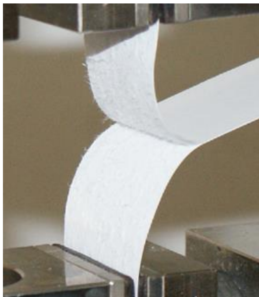
Рис. 5.3. Розрив ламінованого відбитка лазерного паперу Fujicolor під час тестування на розшарування
