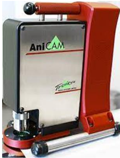
Рис. 2.10. Загальний вигляд приладу AniCam для вимірювання структури та профілю поверхні відбитків [131]
