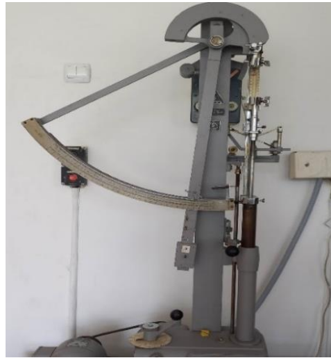
Рис. 2.8. Загальний вигляд розривної машини РМБ-30-2М
