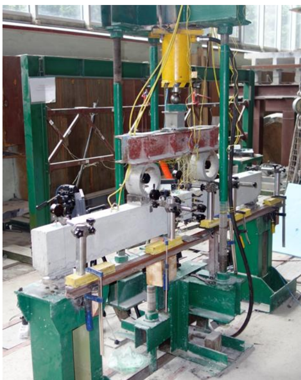
Рис.2.21: а) схематичне зображення випробувального станда і розміщення приладів (Con- для вимірювання деформацій бетону, Reb- для вимірювання деформацій арматури, Dyn-динамометри, Def-прогиноміри); б) загальний вигляд випробувального станда; в) розміщення суб-мікронних індикаторів.
