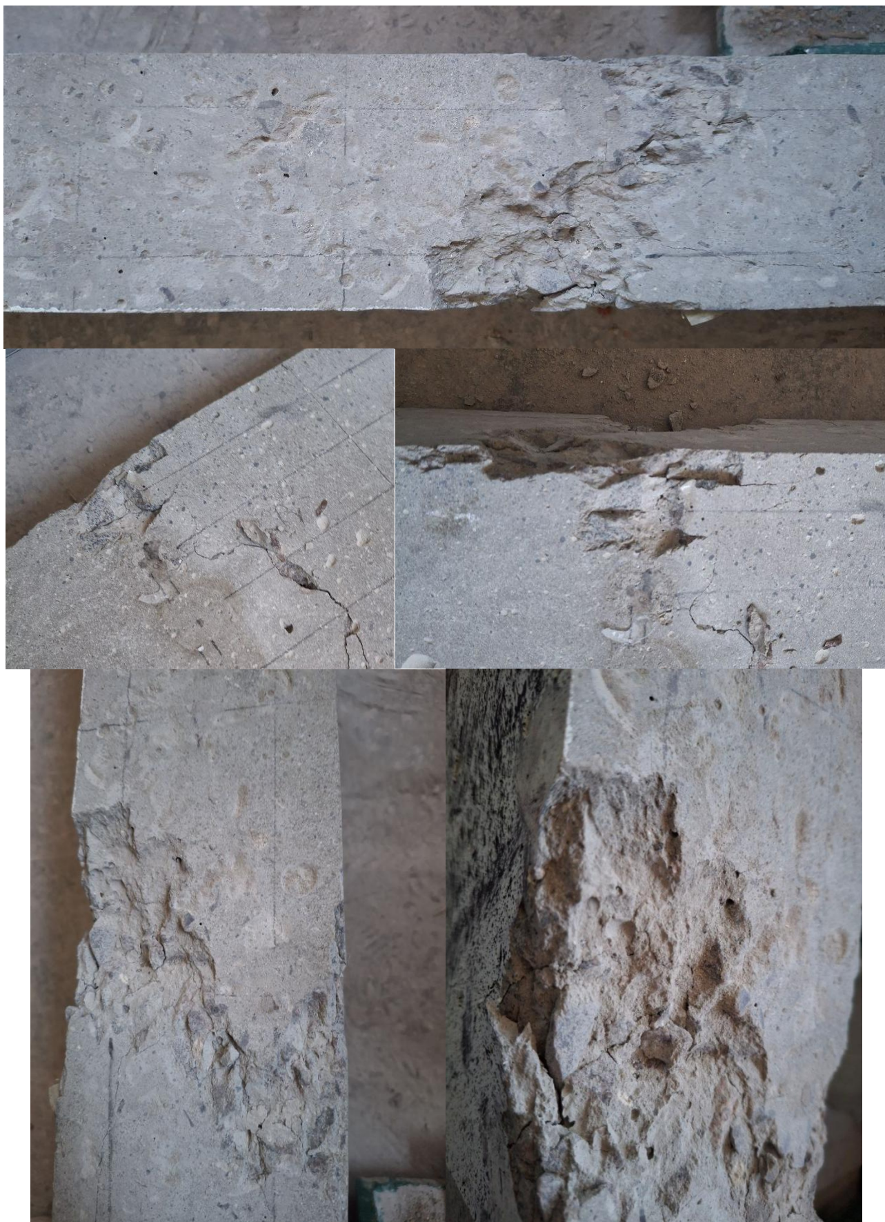
Рис. Г.3 (продовження). Фотофіксація випробуваних дослідних балок ПБ-3-7 і ПБ-3-8: в) руйнування стиснутої зони бетону.
