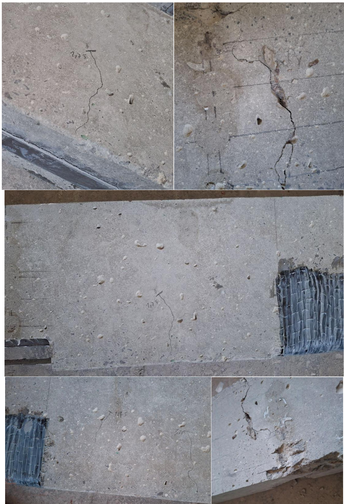
Рис. Г.3 (продовження). Фотофіксація випробуваних дослідних балок ПБ-3-7 і ПБ-3-8: б) поширення тріщин в центральній зоні чистого згину.
