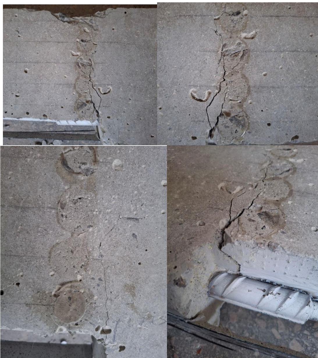
Рис. Г.5 (продовження). Фотофіксація випробуваних дослідних балок ПБ-5-11 і ПБ-5-12: а) загальний вигляд випробуваних зразків; б) поширення тріщин в центральній зоні чистого згину.
