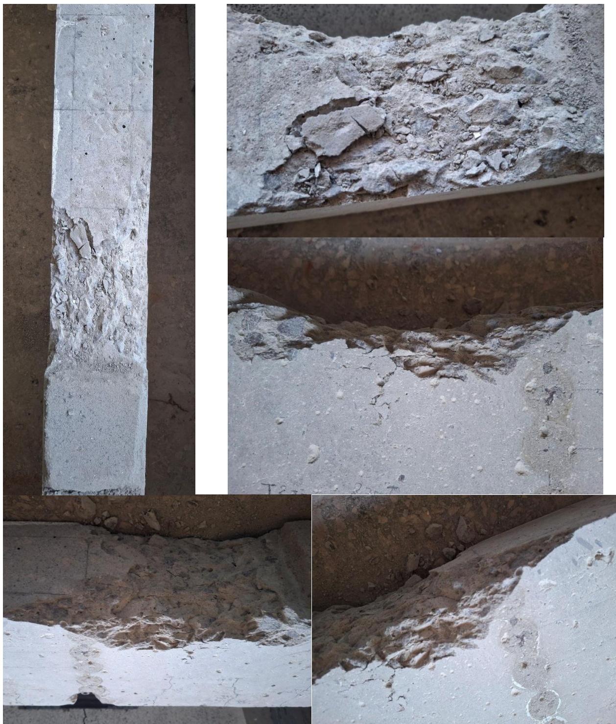
Рис. Г.1 (продовження). Фотофіксація випробуваних дослідних балок ПБ-1-3 і ПБ-1-4: в) руйнування стиснутої зони.
