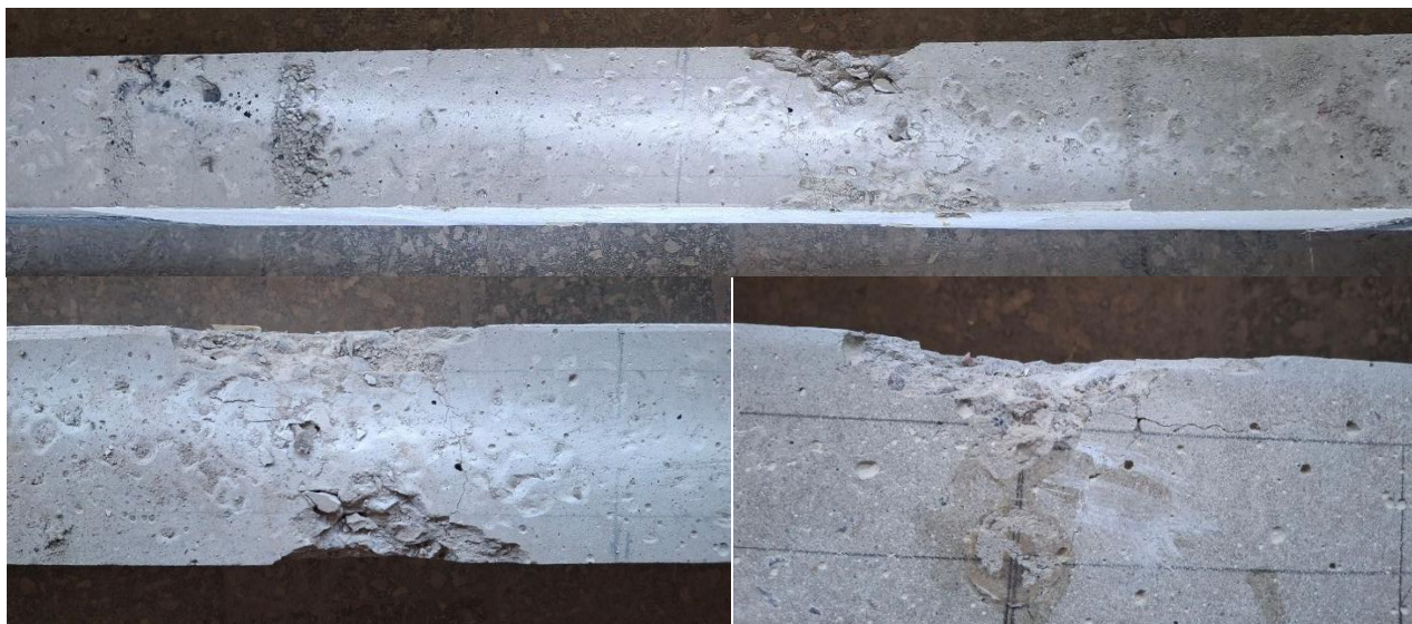
Рис. Г.2 (продовження). Фотофіксація випробуваних дослідних балок ПБ-2-5 і ПБ-2-6: в) руйнування стиснутої зони.
