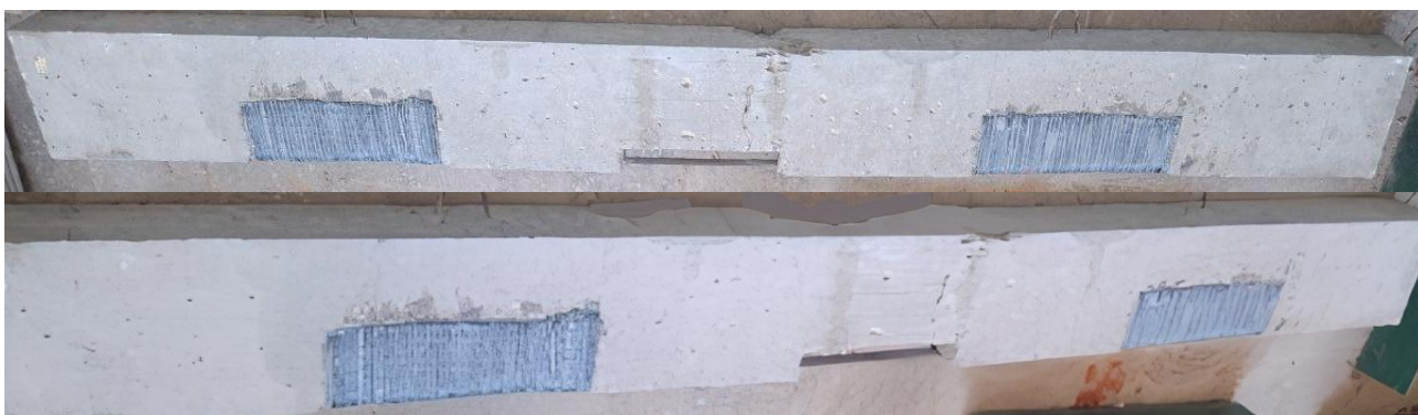
Рис. Г.2 (продовження). Фотофіксація випробуваних дослідних балок ПБ-2-5 і ПБ-2-6: в) руйнування стиснутої зони.
