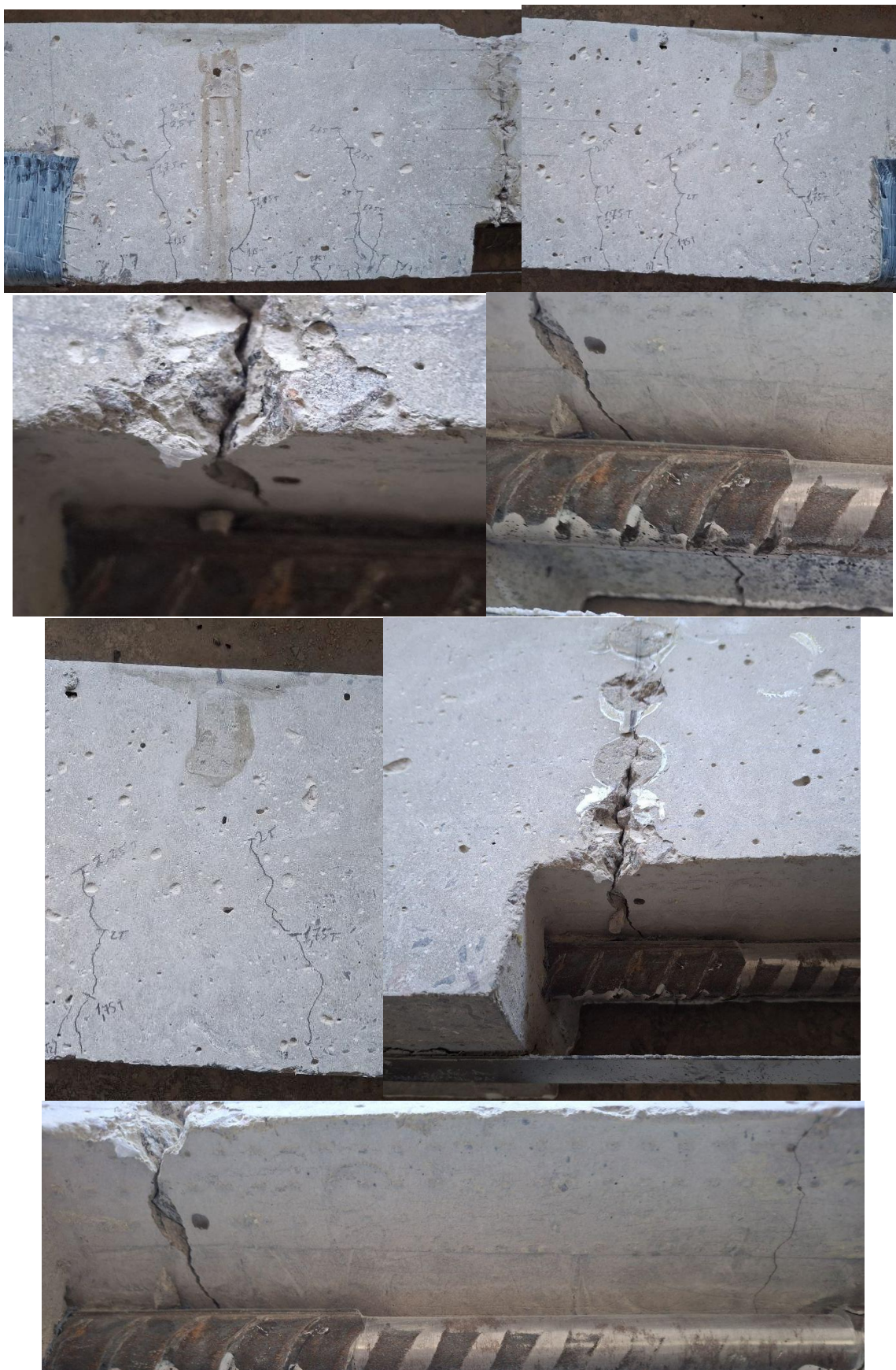
Рис. Г.2 (продовження). Фотофіксація випробуваних дослідних балок ПБ-2-5 і ПБ-2-6: б) поширення тріщин в центральній зоні чистого згину
