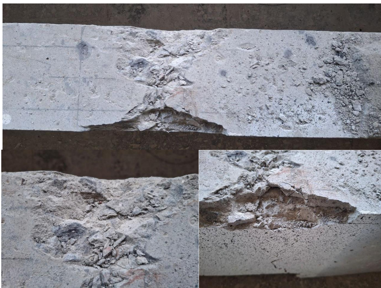
Рис. Г.5 (продовження). Фотофіксація випробуваних дослідних балок ПБ-5-11 і ПБ-5-12: б) поширення тріщин в центральній зоні чистого згину; в) руйнування стиснутої зони бетону.
