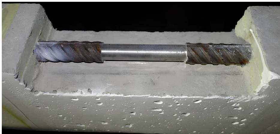
Рис. 2.17. Сточування робочої арматури для моделювання рівномірної корозії
