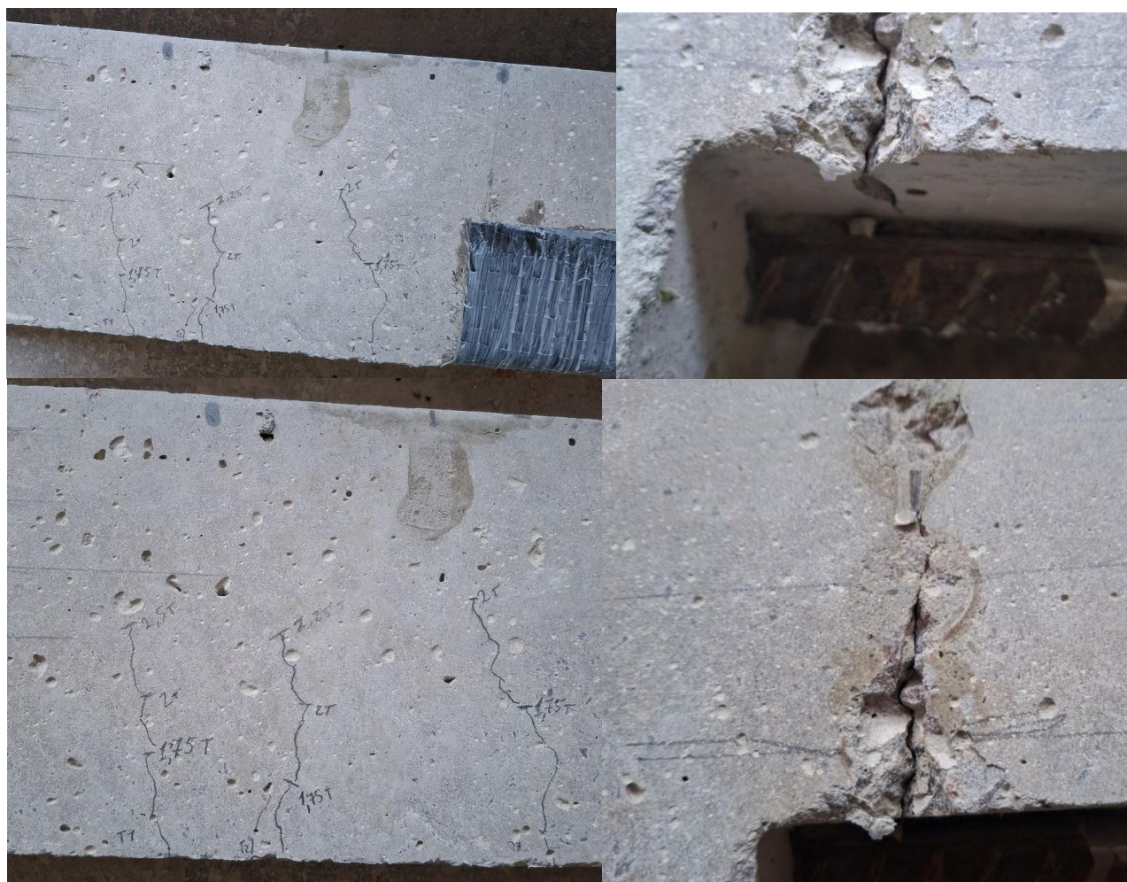
Рис. Г.2 (початок). Фотофіксація випробуваних дослідних балок ПБ-2-5 і ПБ-2-6: а) загальний вигляд випробуваних зразків; б) поширення тріщин в центральній зоні чистого згину
