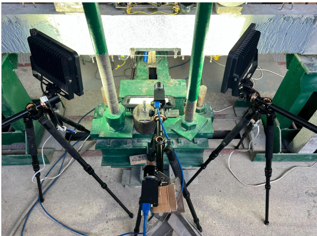
Рис.2.24. Розміщення камер і освітлення для фіксації деформацій методом ЦКЗ.
