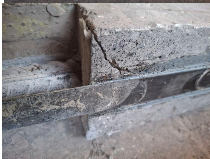
Рис. Г.4 (початок). Фотофіксація випробуваних дослідних балок ПБ-4-9 і ПБ-4-10: а) загальний вигляд випробуваних зразків; б) поширення тріщин в центральній зоні чистого згину.
