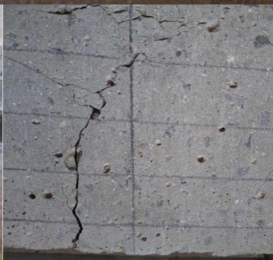
Рис. Г.4 (початок). Фотофіксація випробуваних дослідних балок ПБ-4-9 і ПБ-4-10: а) загальний вигляд випробуваних зразків; б) поширення тріщин в центральній зоні чистого згину.
