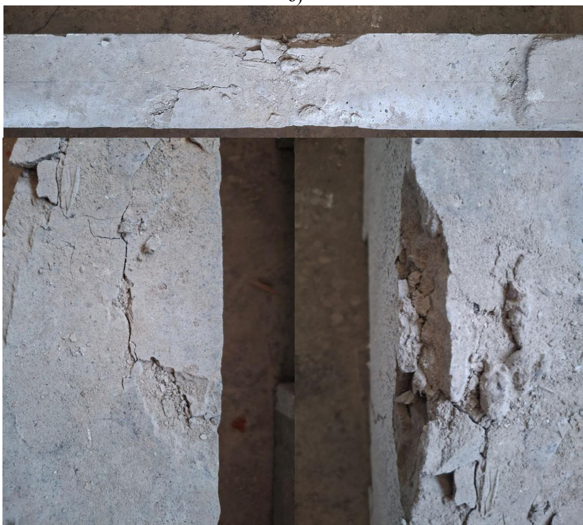
Рис. Г.4 (продовження). Фотофіксація випробуваних дослідних балок ПБ-4-9 і ПБ-4-10: б) поширення тріщин в центральній зоні чистого згину; в) руйнування стиснутої зони бетону.
