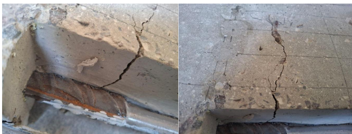
Рис. Г.3 (початок). Фотофіксація випробуваних дослідних балок ПБ-3-7 і ПБ-3-8: а) загальний вигляд випробуваних зразків; б) поширення тріщин в центральній зоні чистого згину.
