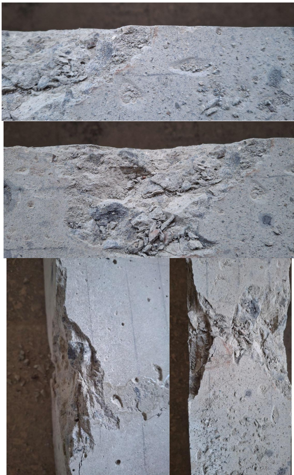
Рис. Г.5 (продовження). Фотофіксація випробуваних дослідних балок ПБ-5-11 і ПБ-5-12: в) руйнування стиснутої зони бетону.
