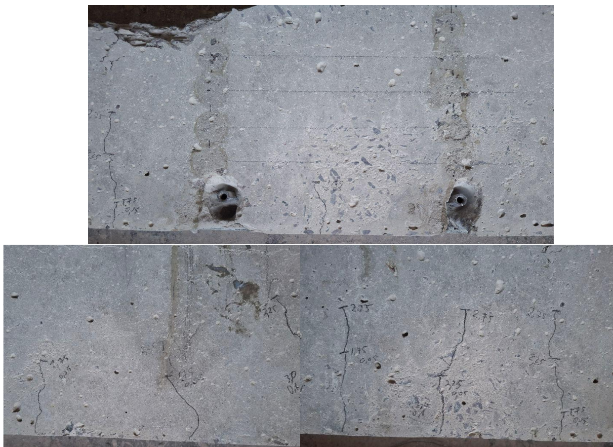
Рис. Г.1 (початок). Фотофіксація випробуваних дослідних балок ПБ-1-3 і ПБ-1-4: а) загальний вигляд випробуваних зразків; б) поширення тріщин в центральній зоні чистого згину; в) руйнування стиснутої зони.
