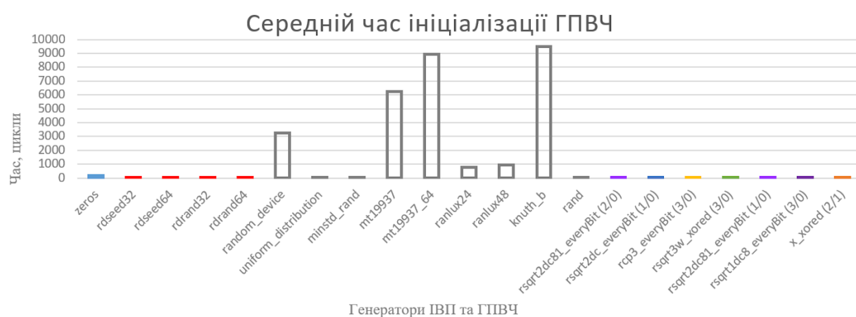
Рисунок Е.3 – Порівняння швидкодії доступних і запропонованих методів генерації ПВЧ та ІВП на Intel: (а) швидкість генерації ПВП на Intel i5, (б) швидкість генерації ПВП на Intel i7 та (в) час ініціалізації ГПВЧ на Intel i5
