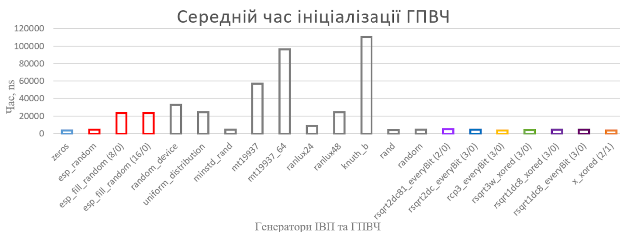
Рисунок Е.4 – Порівняння швидкості доступних і запропонованих методів генерації ПВЧ та ІВП на МК ESP-32: (а) швидкість генерації ПВП та (б) час ініціалізації ГПВЧ
