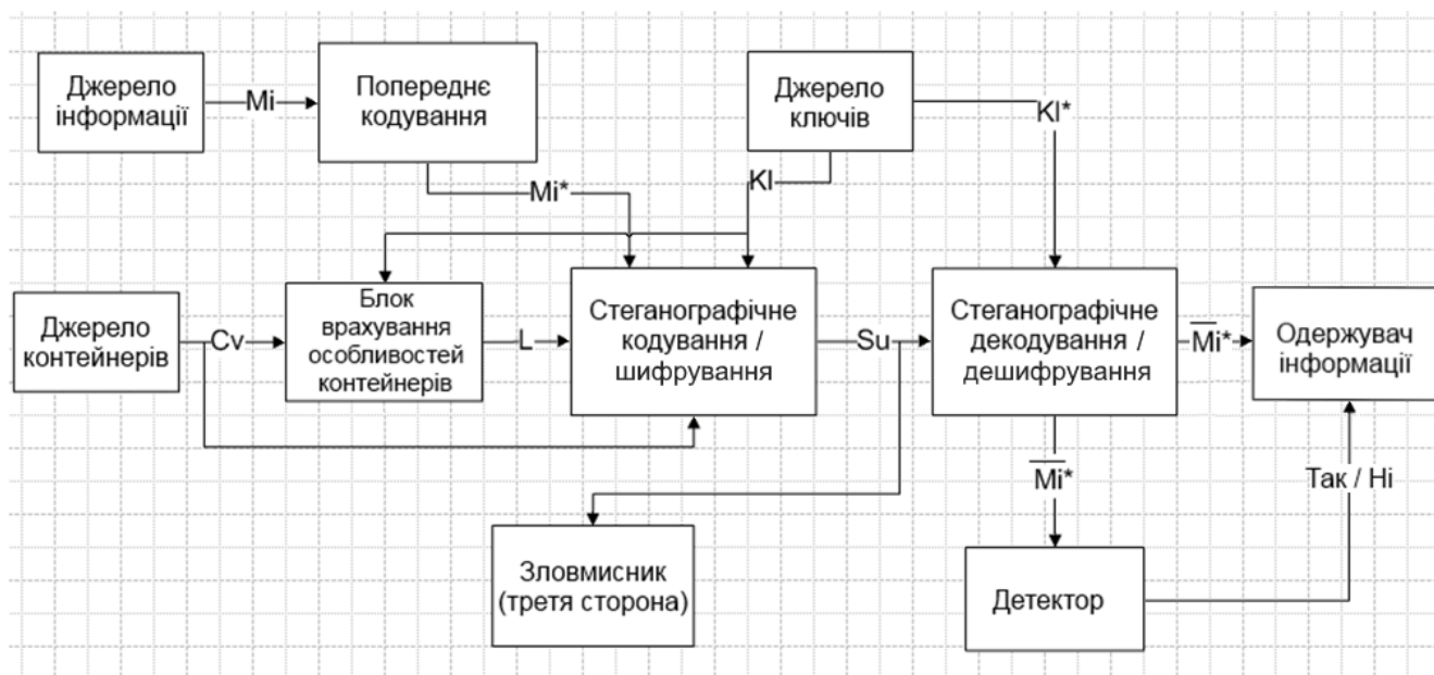
Рисунок 4.11 – Використана вдосконалена модель стеганосистеми на основі аналізу особливостей контейнера C_v , що використовує ключі мінімального розміру на основі ГПВЧ
