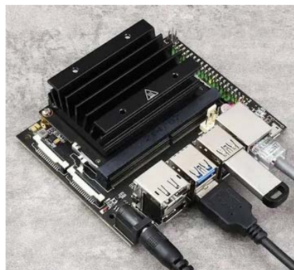
Рисунок 4.4. Периферійний пристрій NVIDIA Jetson Nano, який встановлений на Formica-1 AGV.
