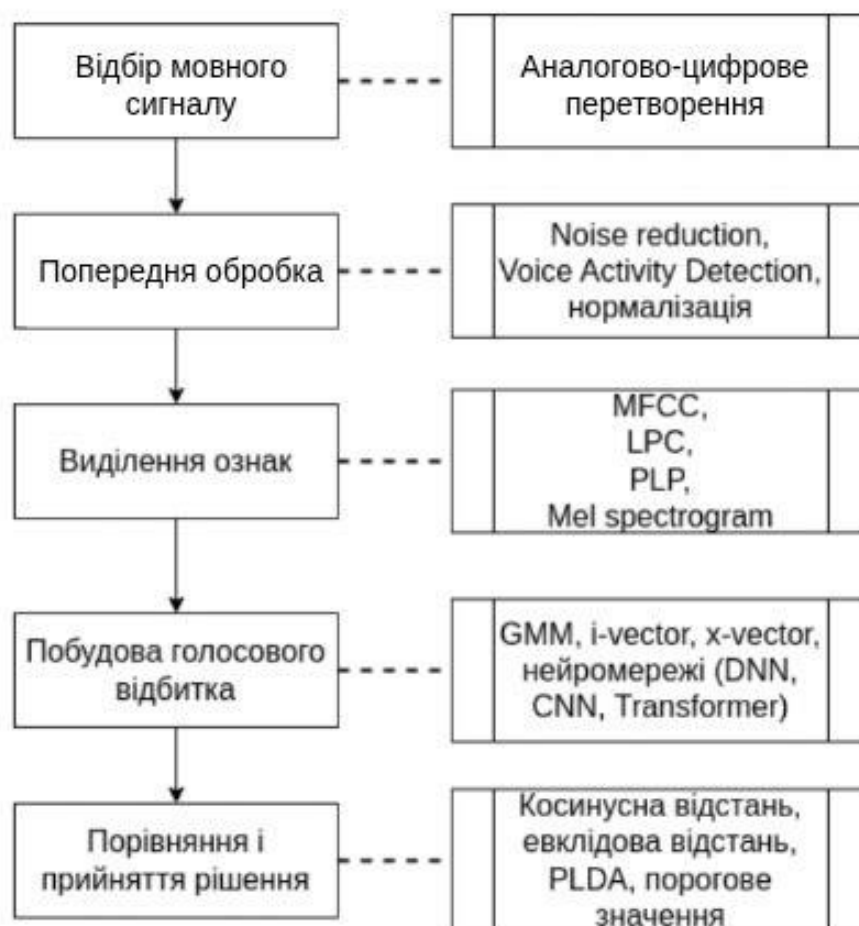
Рисунок 2.2. Структурна схема процесу обробки голосового сигналу в системах біометричної автентифікації
