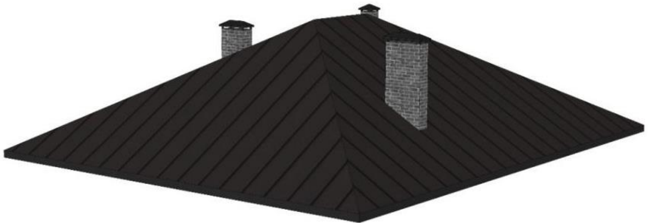
Рис. 3.4.5. Аксонометрична схема фальцевої покрівлі будинку (рисунок автора)
