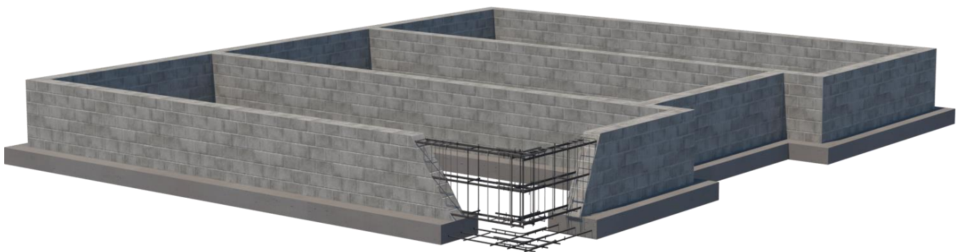
Рис.3.1.2. Аксонометрична схема стрічкового збірно-монолітного фундаменту із блоків для незнімної опалубки (рисунок автора)
