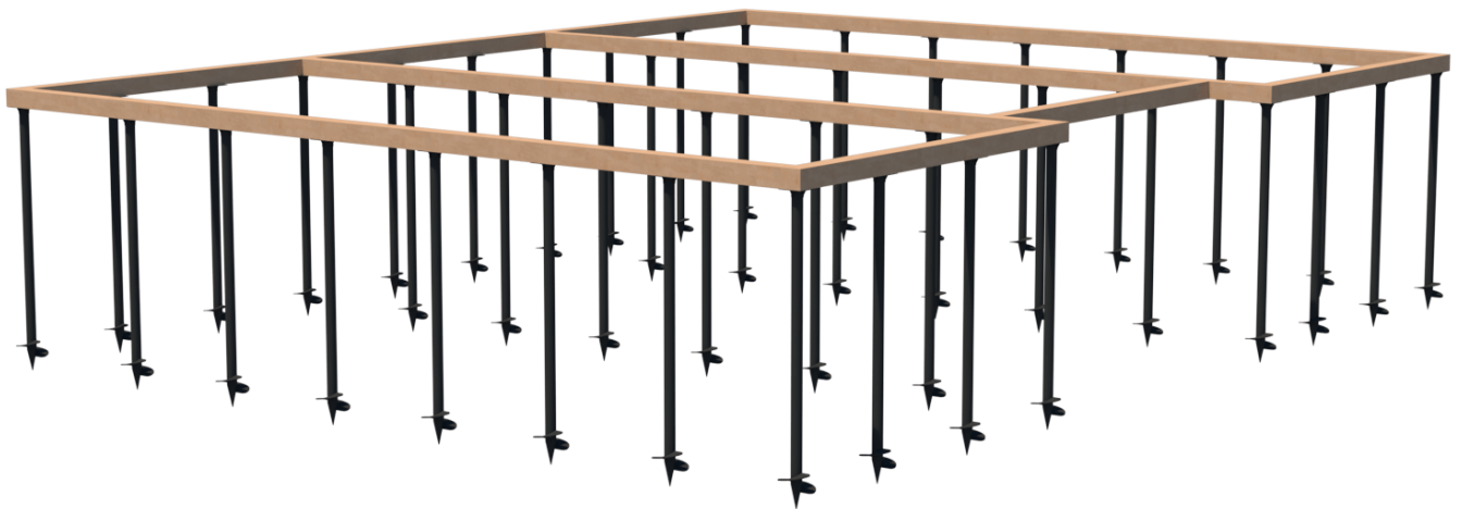
Рис. 3.1.6. Аксонометрична схема палевого фундаменту із низьким стрічковим ростверком (рисунок автора)
