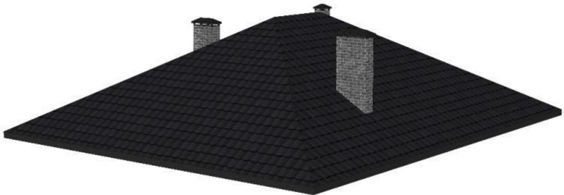
Рис. 3.4.1 Аксонометрична схема покрівлі будинку із металочерепиці (рисунок автора)
