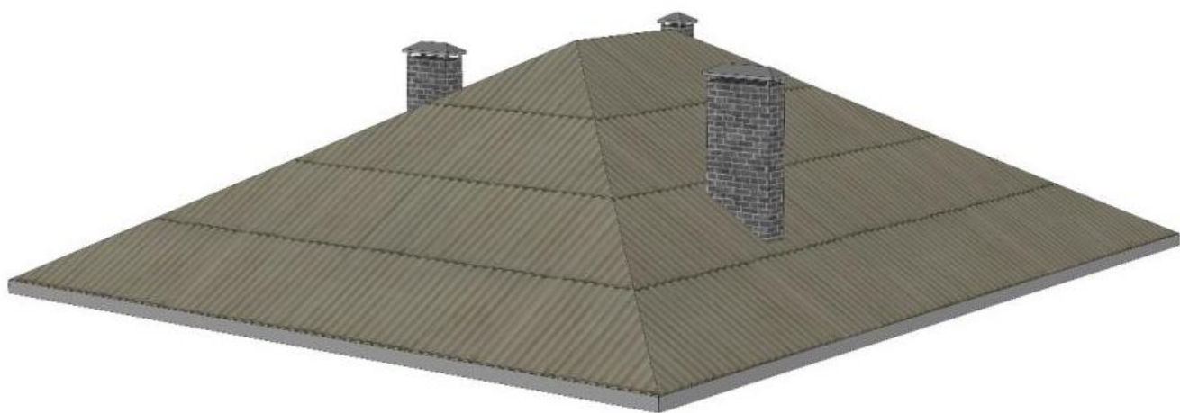
Рис. 3.4.7. Аксонометрична схема покрівлі будинку з шиферу (рисунок автора)
