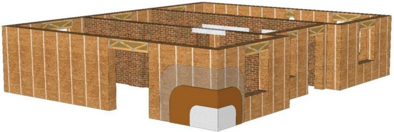
Рис. 3.2.6. Система зовнішніх стін із солом'яних панелей (рисунок автора)
