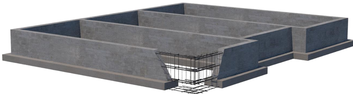
Рис. 3.1.1. Аксонометрична схема монолітного стрічкового фундаменту (рисунок автора)
