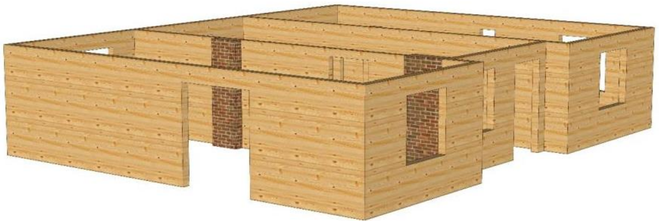
Рис. 3.2.4. Система зовнішніх стін із дерев'яного клеєного бруса (рисунок автора)
