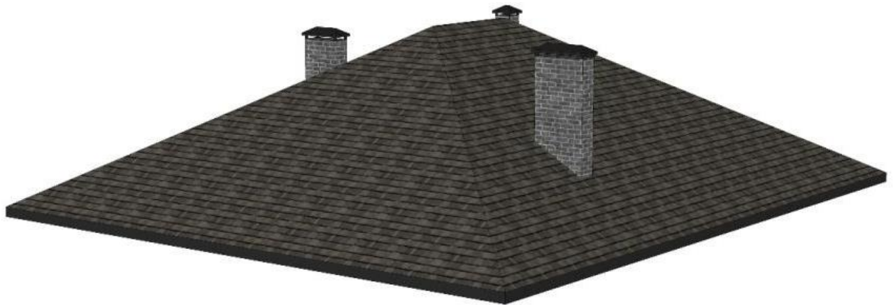
Рис. 3.4.4. Аксонометрична схема покрівлі будинку із бітумної черепиці (рисунок автора)
