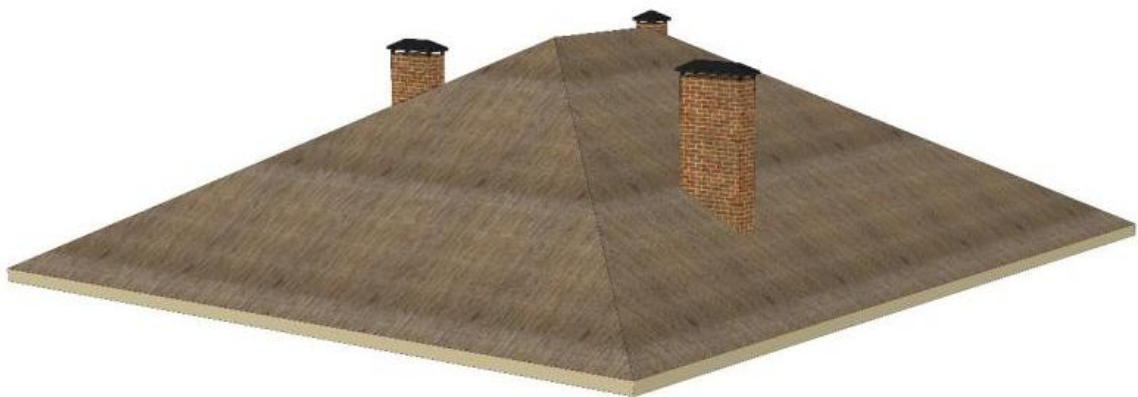
Рис. 3.4.8. Аксонометрична схема покрівлі будинку очерету (рисунок автора)
