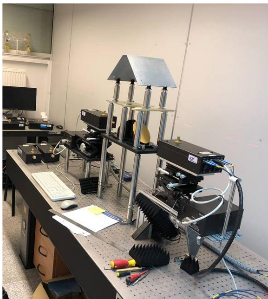
Рис. 2.18. Загальний вигляд спрощеної експериментальної установки для вимірювання показника заломлення матеріалів оптоелектронних елементів в суб-ТГц діапазоні хвиль
