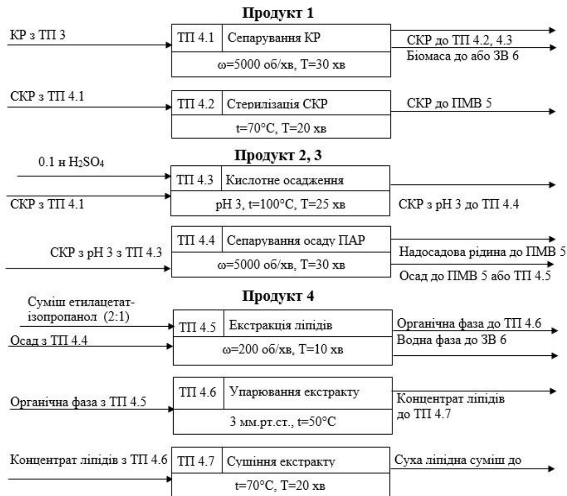
Рис. 6.3. Технологічна схема одержання поверхнево-активних продуктів штаму Pseudomonas sp. PS-17 (цільові продукти)
