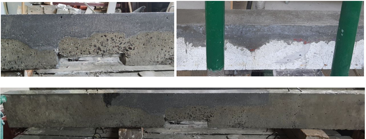
Рис. 2.20. Загальний вигляд залізобетонної балки після відновлення стиснутої зони бетону
