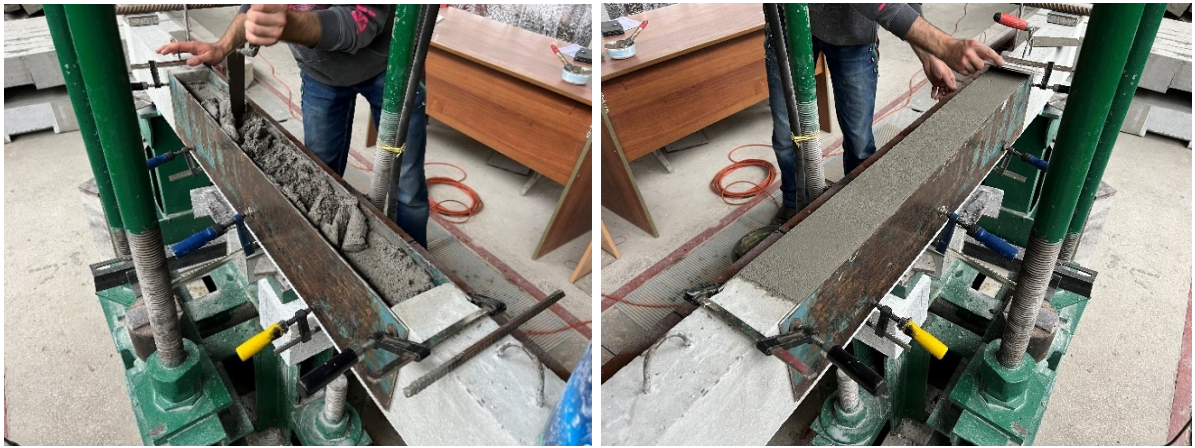
Рис. 2.19. Укладання розчину Sika MonoTop-4012
