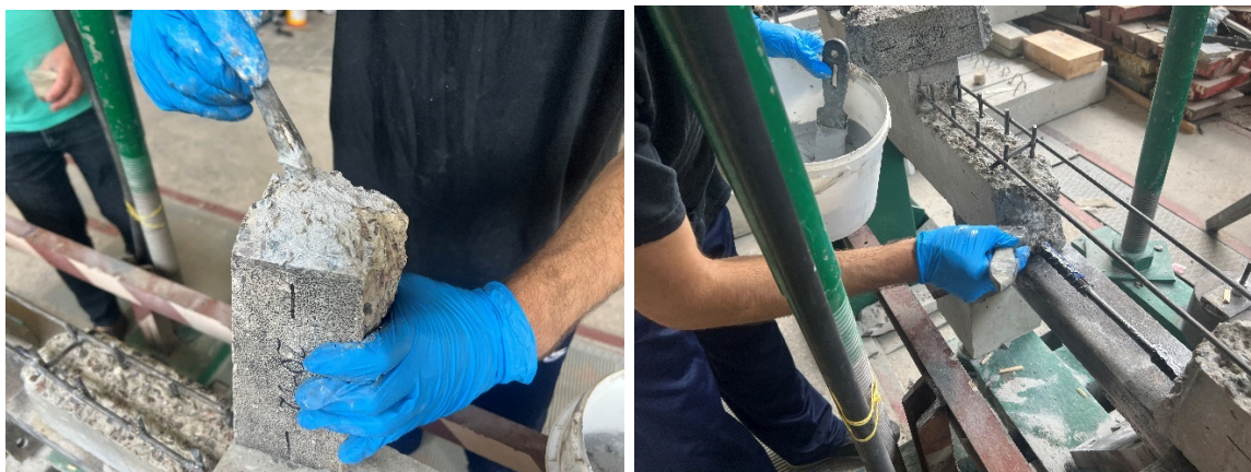
Рис. 2.24. Нанесення епоксидного клею на поверхні
