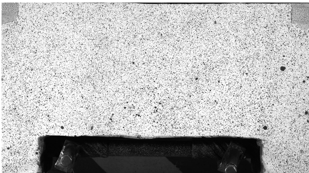
Рис. 2.51. Нанесені спекли на бетон
