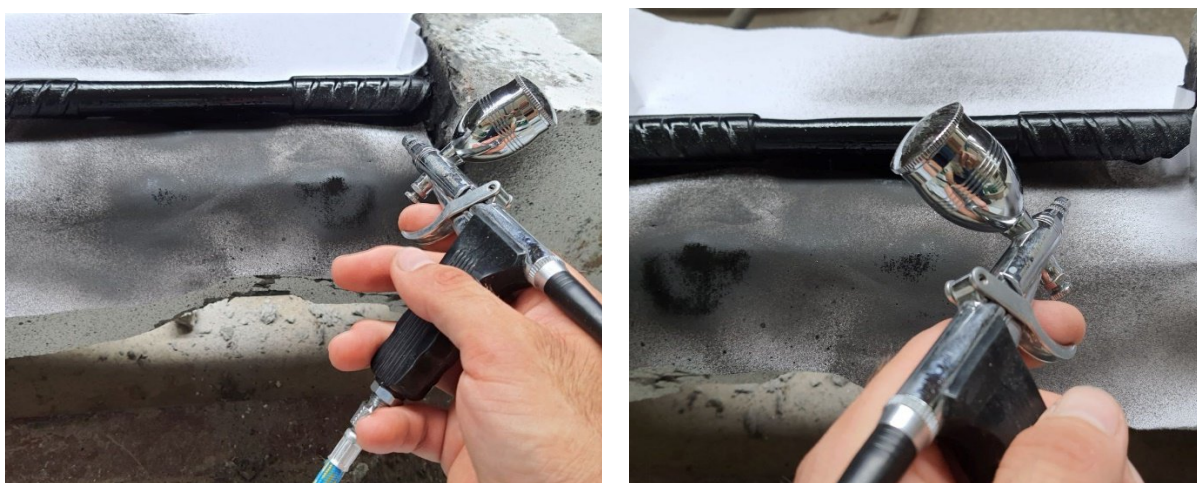
Рис. 2.49. Нанесення спеклів на робочу арматуру за допомогою аерографа
