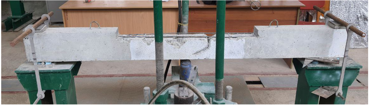
Рис. 2.15. Етап розвантаження залізобетонної балки на стенді
