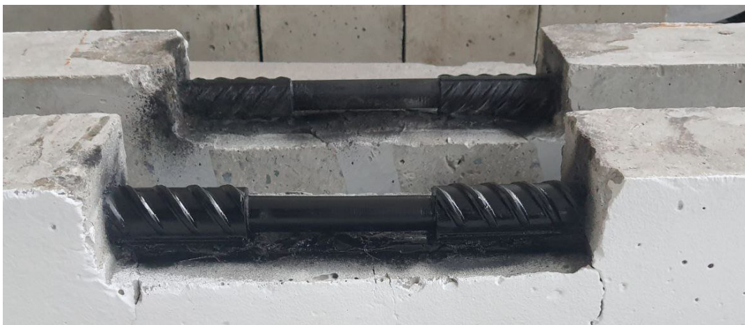
Рис. 2.5. Вид отвору на досліджуваних балках для доступу до розтягнутої робочої арматури при використанні методу ЦКЗ
