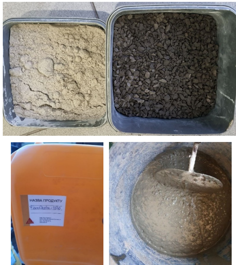
Рис. 2.30. Компоненти дрібнозернистого бетону
