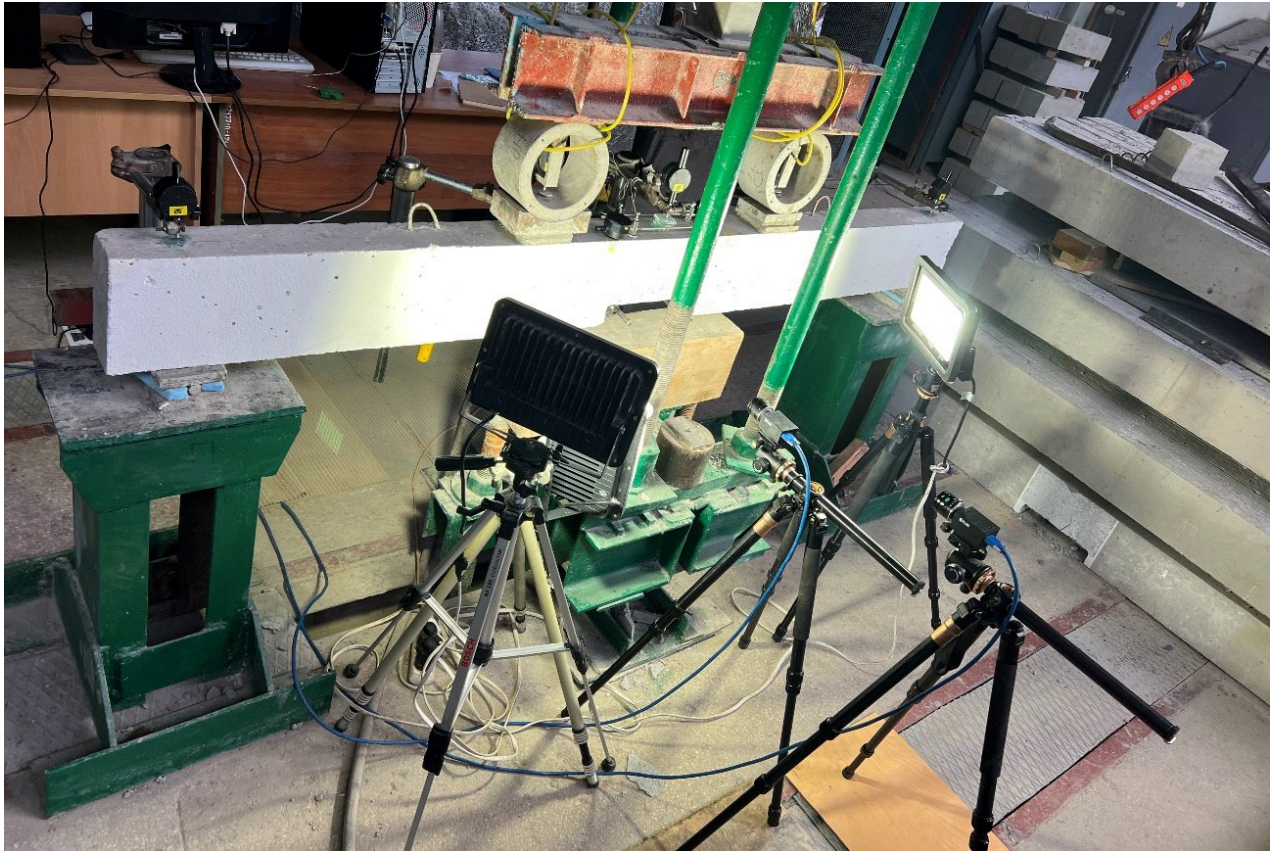
Рис. 2.53. Вигляд дослідного стенду із розміщенням камер для ЦКЗ
