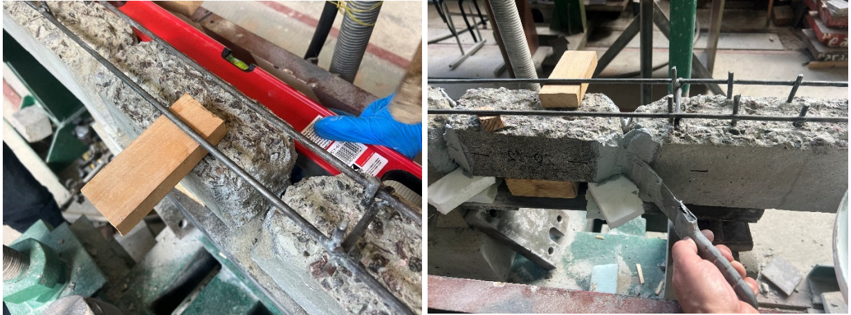
Рис. 2.26. Встановлення вставки в проєктне положення та її фіксація
