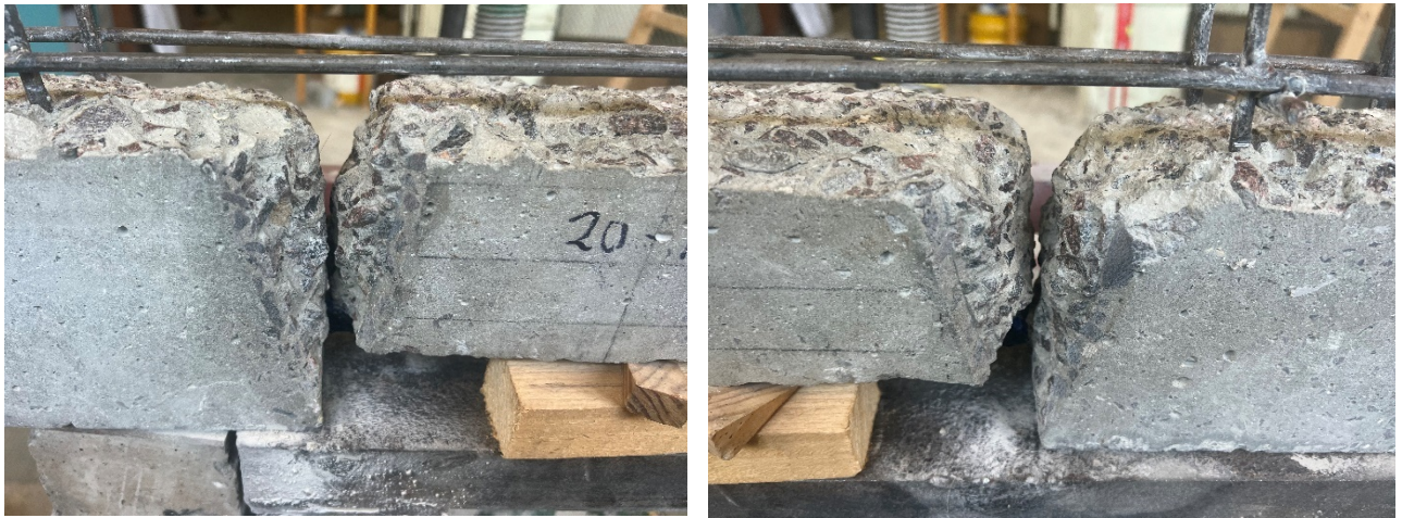
Рис. 2.22. Підготовка поверхні і зазорів для відновлювальних робіт
