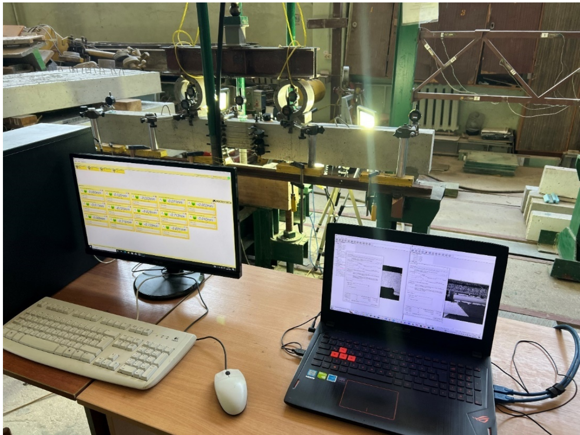
Рис. 2.57. Вид експериментального випробування залізобетонних балок з комплексним використанням сучасних приладів дослідження
