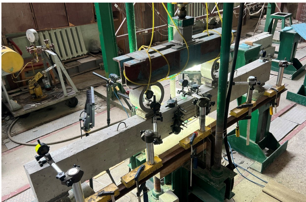
Рис. 2.46. Дійсний вигляд розміщення суб-мікронних індикаторів
