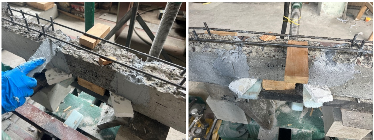
Рис. 2.27. Вдавлювання епоксидного клею
