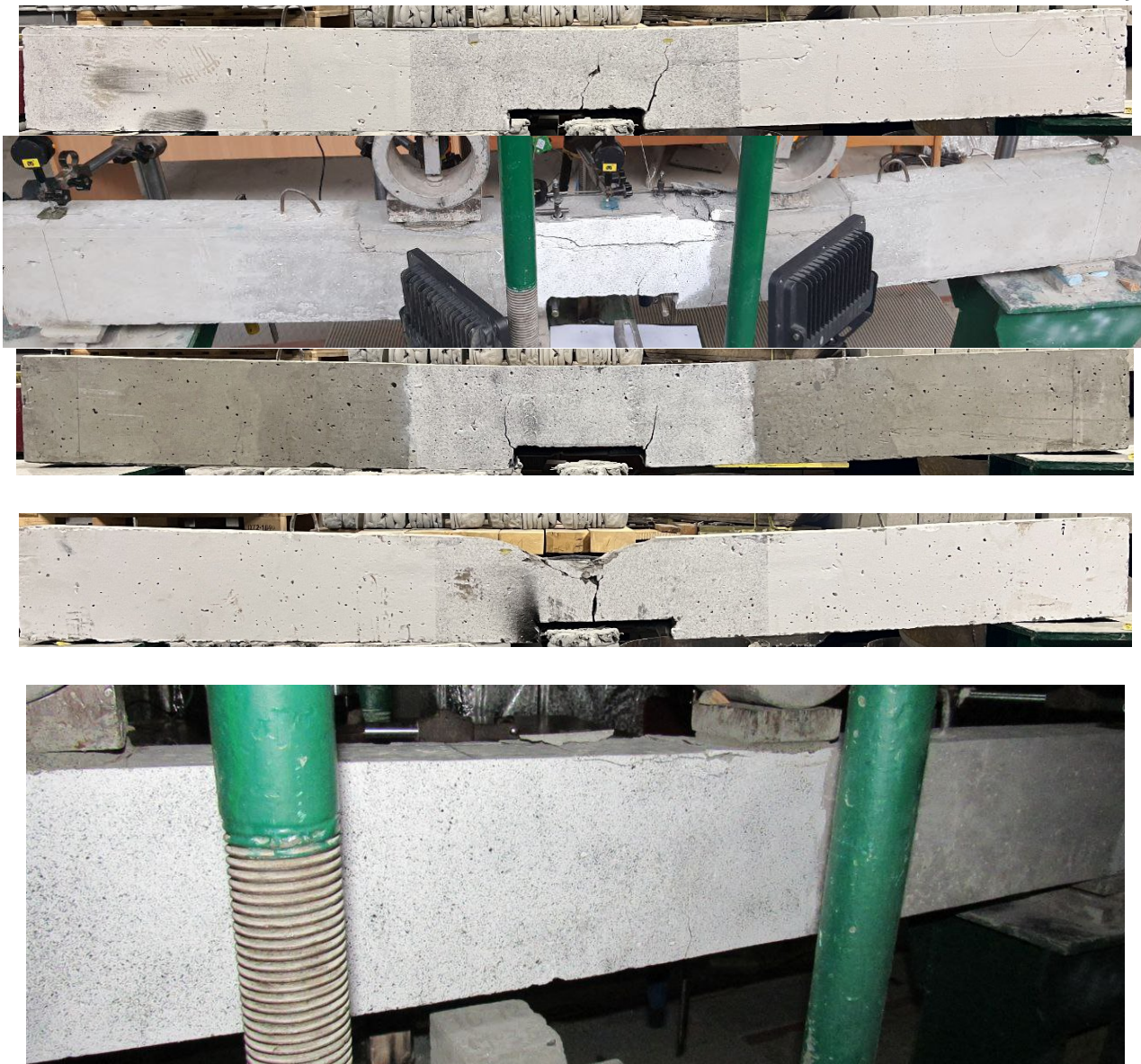
Рис. А.1. Фотофіксація випробуваних дослідних балок 1-ї...8-ї серії
