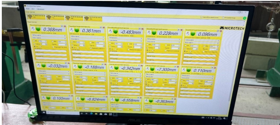
Рис. 2.44. Дані деформацій на ПК від суб-мікронних індикаторів
