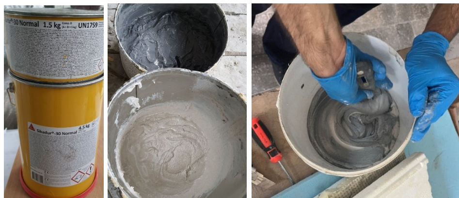
Рис. 2.23. Вигляд і замішування епоксидного клею Sikadur-30
