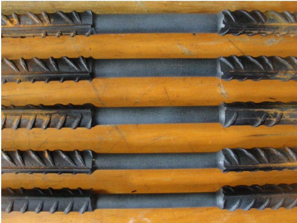
Рис.2.3. Загальний вигляд дослідних зразків арматури класу A500C
