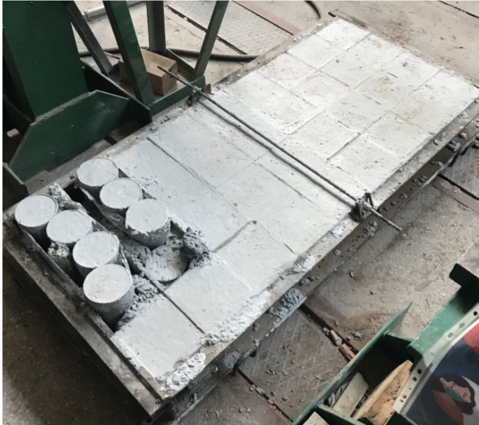
Рис.2.2. Загальний вигляд дослідних зразків бетонних кубів та призм
