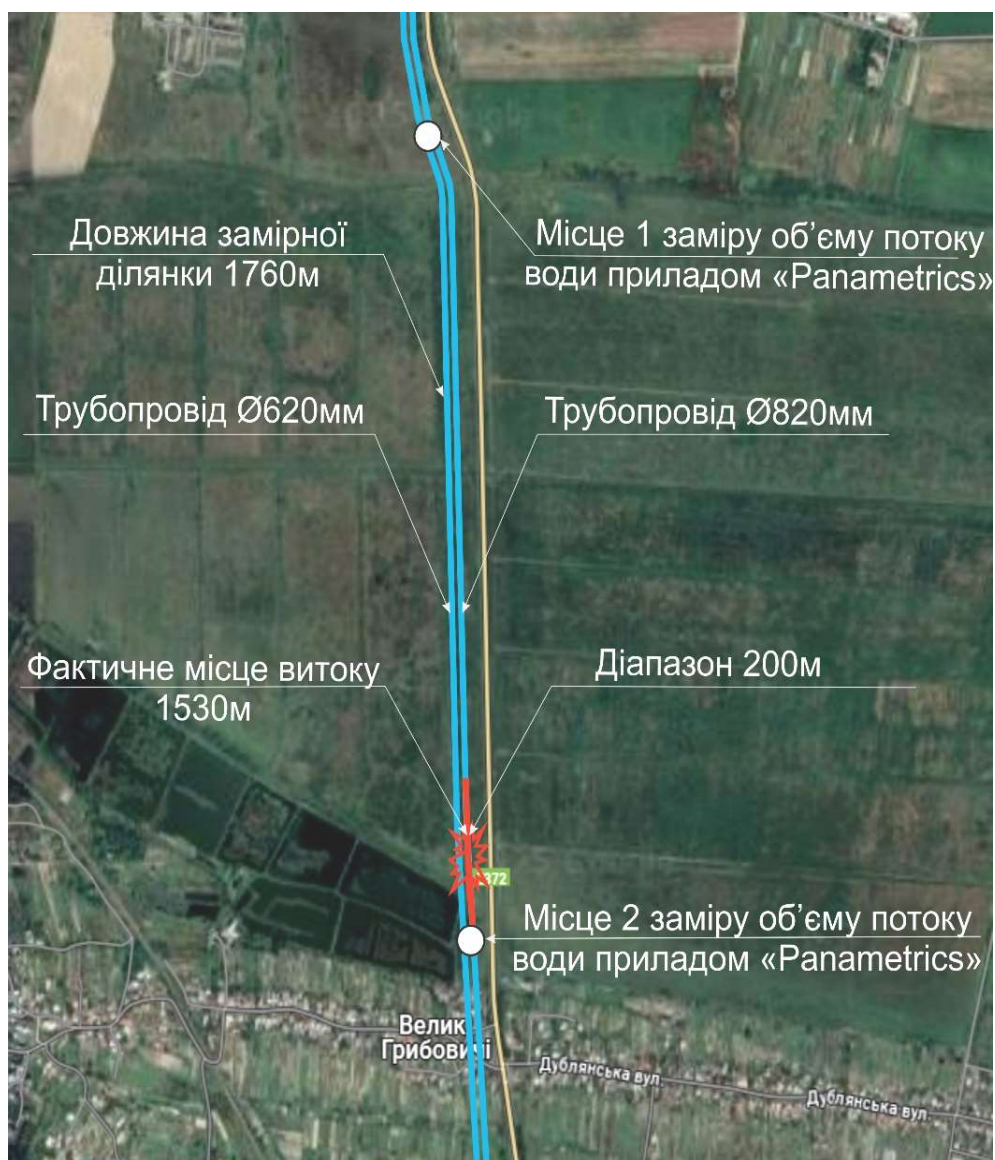
Рис.4.7 Схема ділянки напірного водоводу від ВНС «Зарудці» до ВНС «Збоїща» у м. Львів, Ø820мм, з вказанням діапазону дистанційної локалізації місця витоку та його фактичного розташування.
