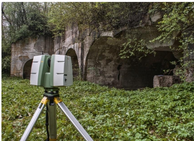
Рис. 2.2. Проведення лазерного сканування сканером Leica ScanStation C10
