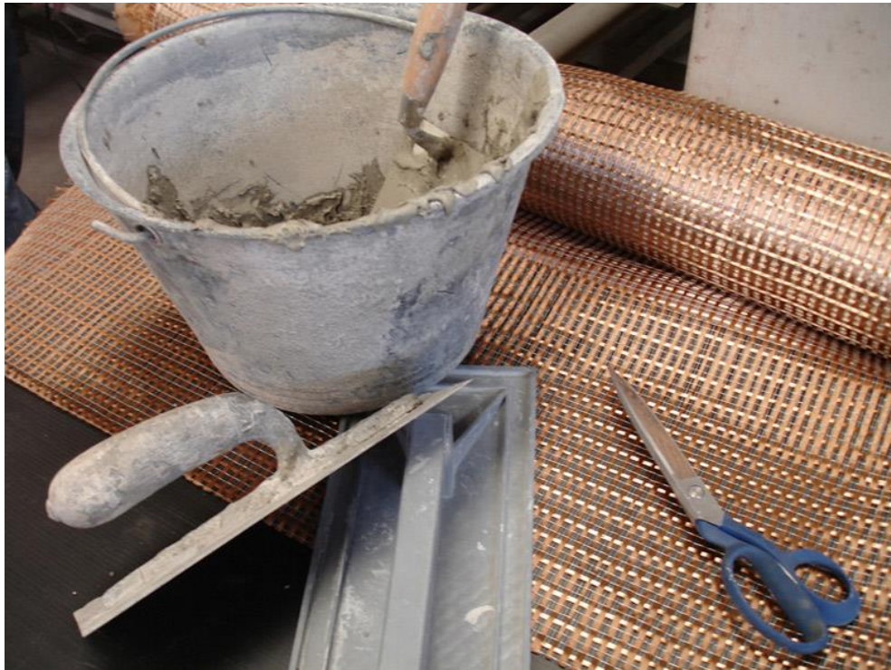
Рис. 2.12. Загальний вигляд матеріалів системи Ruredil X Mesh Gold
