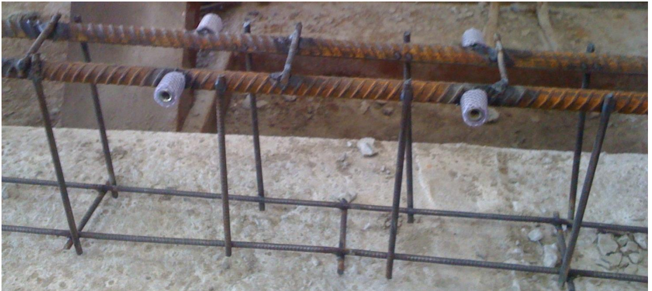
Рис.2.3. Місця приварених тримачів до робочої арматури для визначення деформацій робочої арматури під час досліджень з використанням мікроіндикаторів годинникового типу
