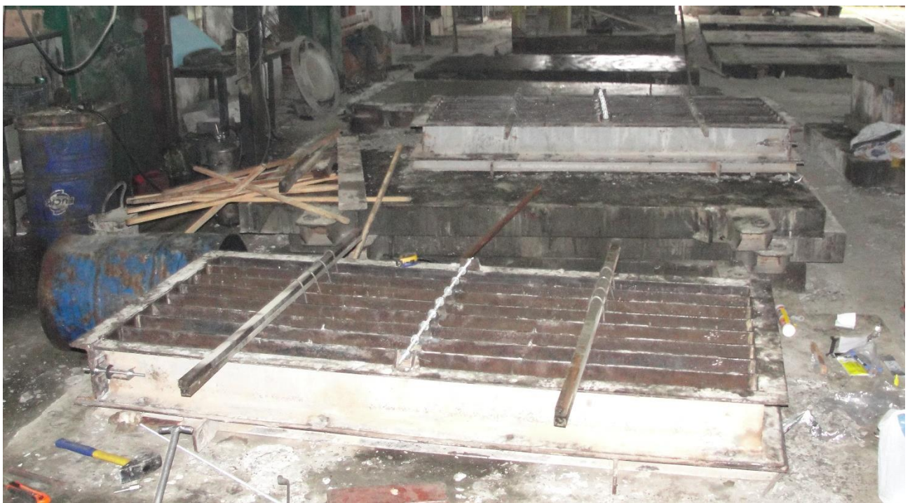
Рис.2.1. Процес виготовлення зразків на заводі залізобетонних виробів
