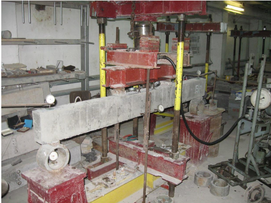
Рис. 2.8. Загальний вигляд передачі навантаження від гідравлічного домкрата на систему тяжів і траверс для підтримки рівня навантаження при підсиленні зразків
