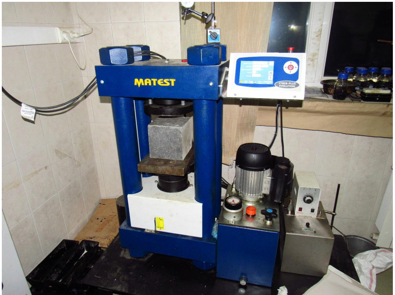
Рис. 2.9. Випробування бетонних кубиків 150x150x150 мм на гідравлічній машині на стиск Matest Cyber-Plus Evolution
