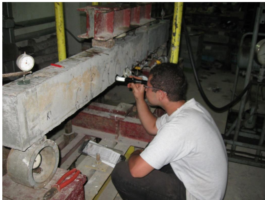
Рис. 2.7. Вимірювання ширини розкриття тріщин під час випробування
