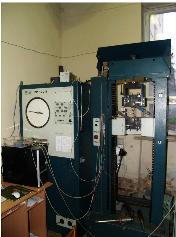
Рис. 2.4. Загальний вигляд розривної машини FP 100/1
