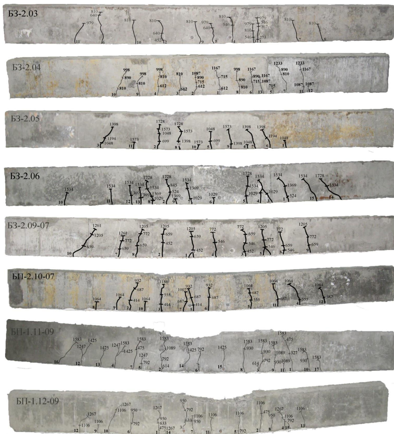
Рис. А.1. Фотофіксація випробуваних дослідних балок
