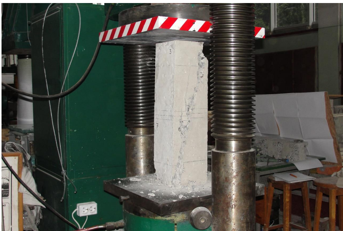
Рис. 2.11. Загальний вигляд випробуваних бетонних призм
