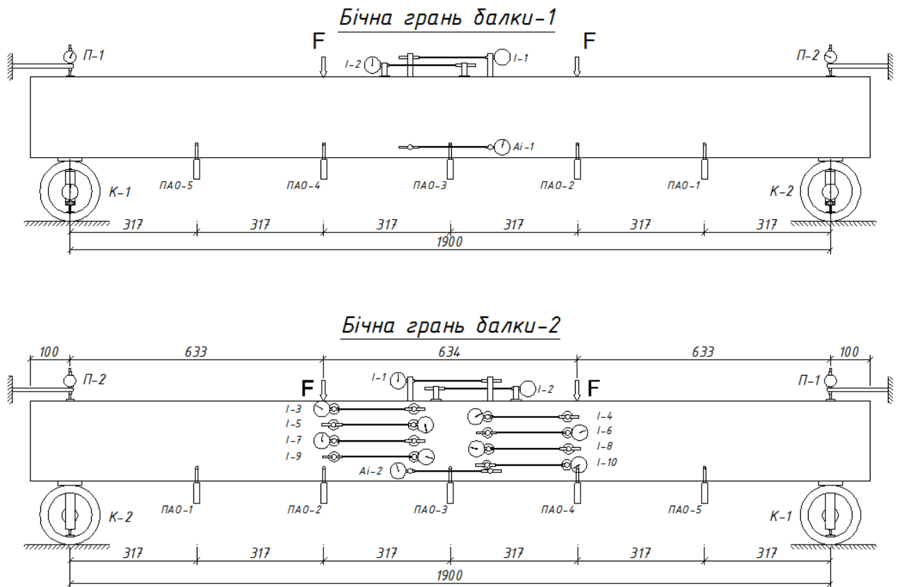
Рис. 2.12. Схема розміщення приладів при випробуванні дослідних залізобетонних балок
