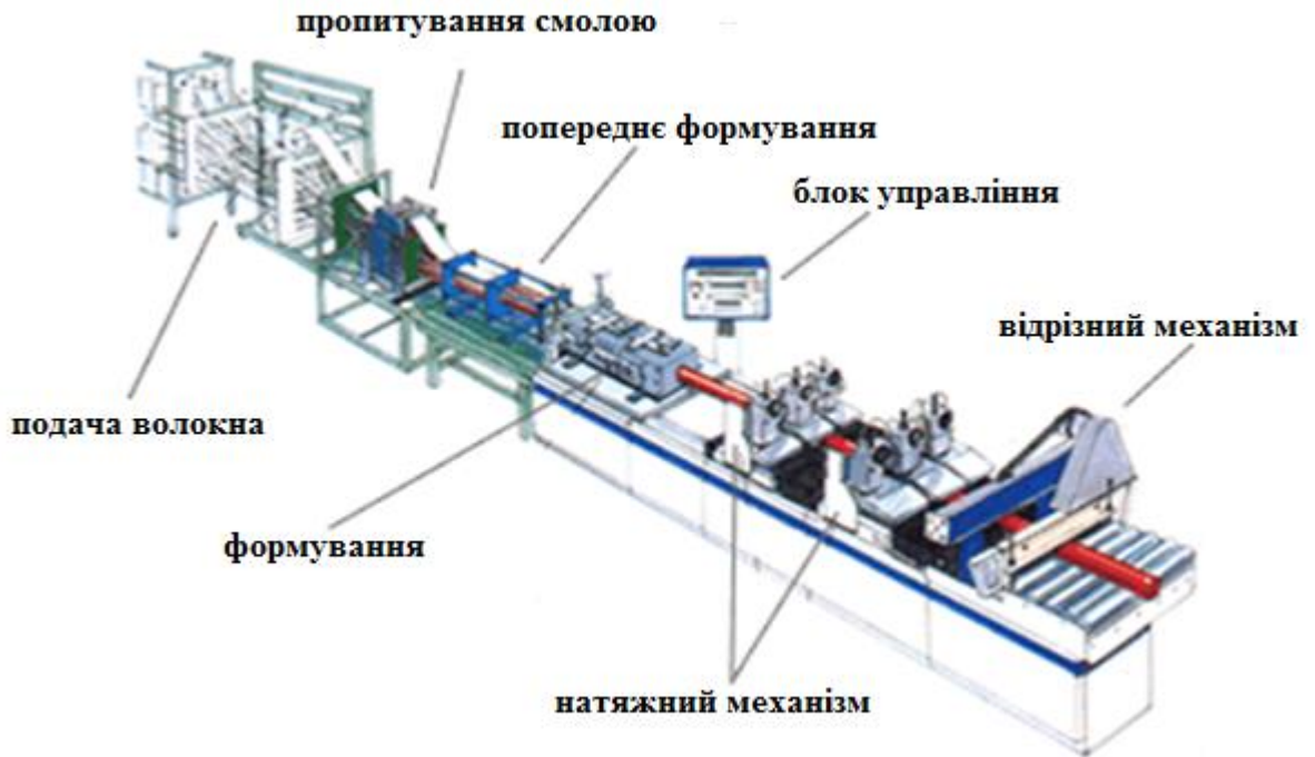
Рис. 1.1 Процес виготовлення композитних матеріалів - пултрузія
