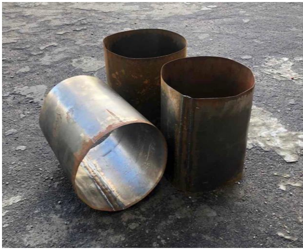
Рис. 4.12. Зварні металеві труби: a – виготовлені зварні металеві труби; б – обрізання труб до необхідного розміру
