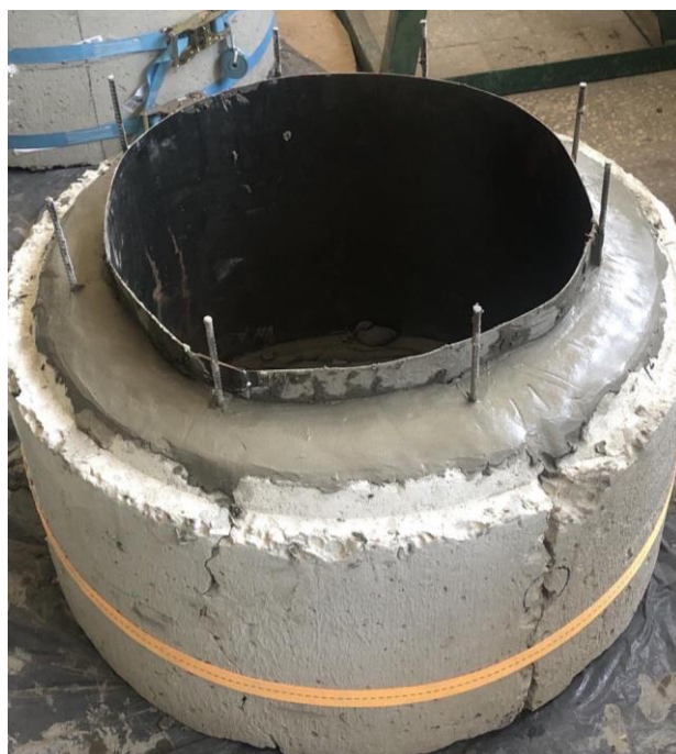
Рис. 4.19. Підсилений арматурним каркасом зразок із заповненим ремонтною сумішшю простором
