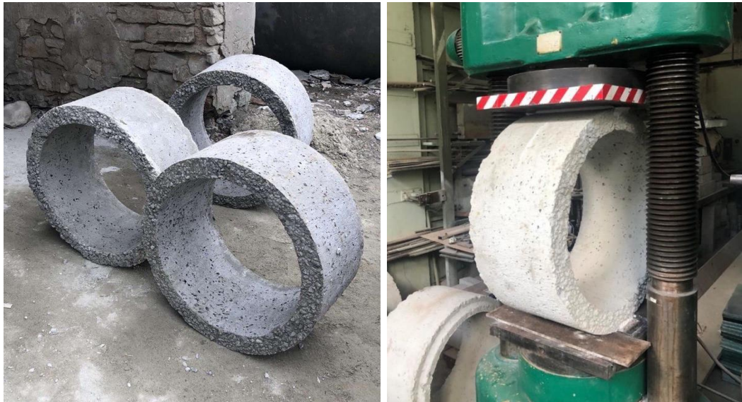
Рис. 4.1. Загальний вигляд дослідних зразків залізобетонної труби серії I
