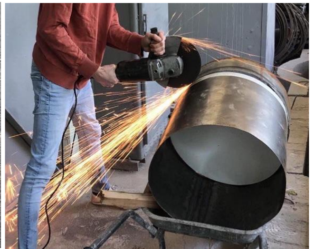
Рис. 4.12. Зварні металеві труби: a – виготовлені зварні металеві труби; б – обрізання труб до необхідного розміру
