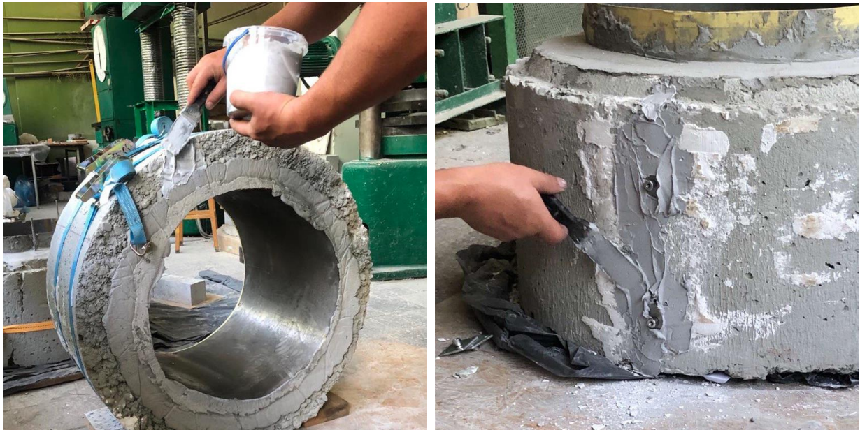
Рис. 4.23. Герметизація поверхні тріщин епоксидною пастою
