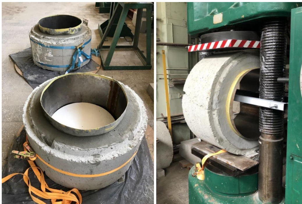
Рис. 4.2. Загальний вигляд дослідних зразків пошкодженої залізобетонної труби підсиленої гільзуванням серії II
