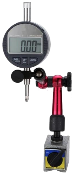
Рис. 4.6. Електронний цифровий індикатор з магнітною базою
