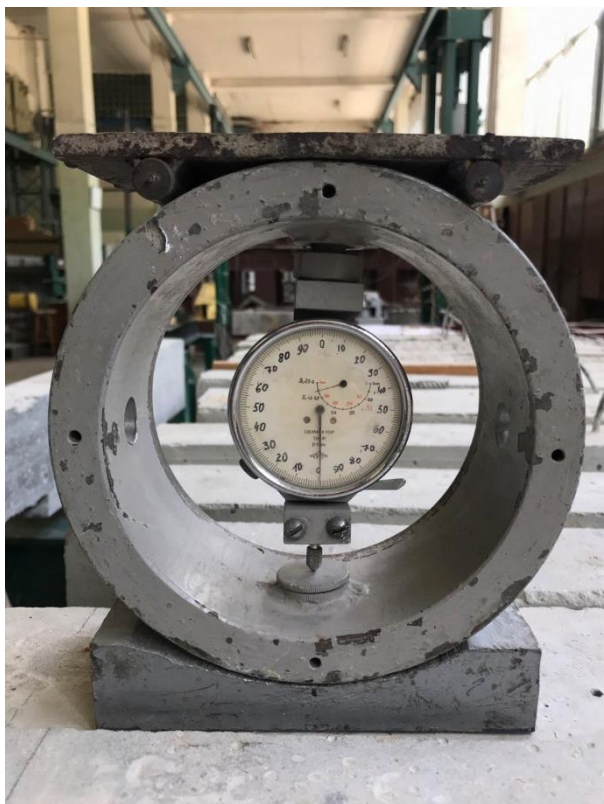
Рис. 4.8. Використане обладнання: а – кільцевий динамометр з індикатором годинникового типу; б – відліковий мікроскоп МПБ-2
