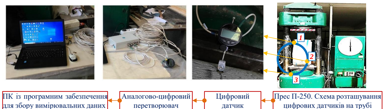
Рис. 4.29. Експериментальна схема для реєстрації деформацій залізобетонної труби на гідравлічному випробувальному пресі П-250
