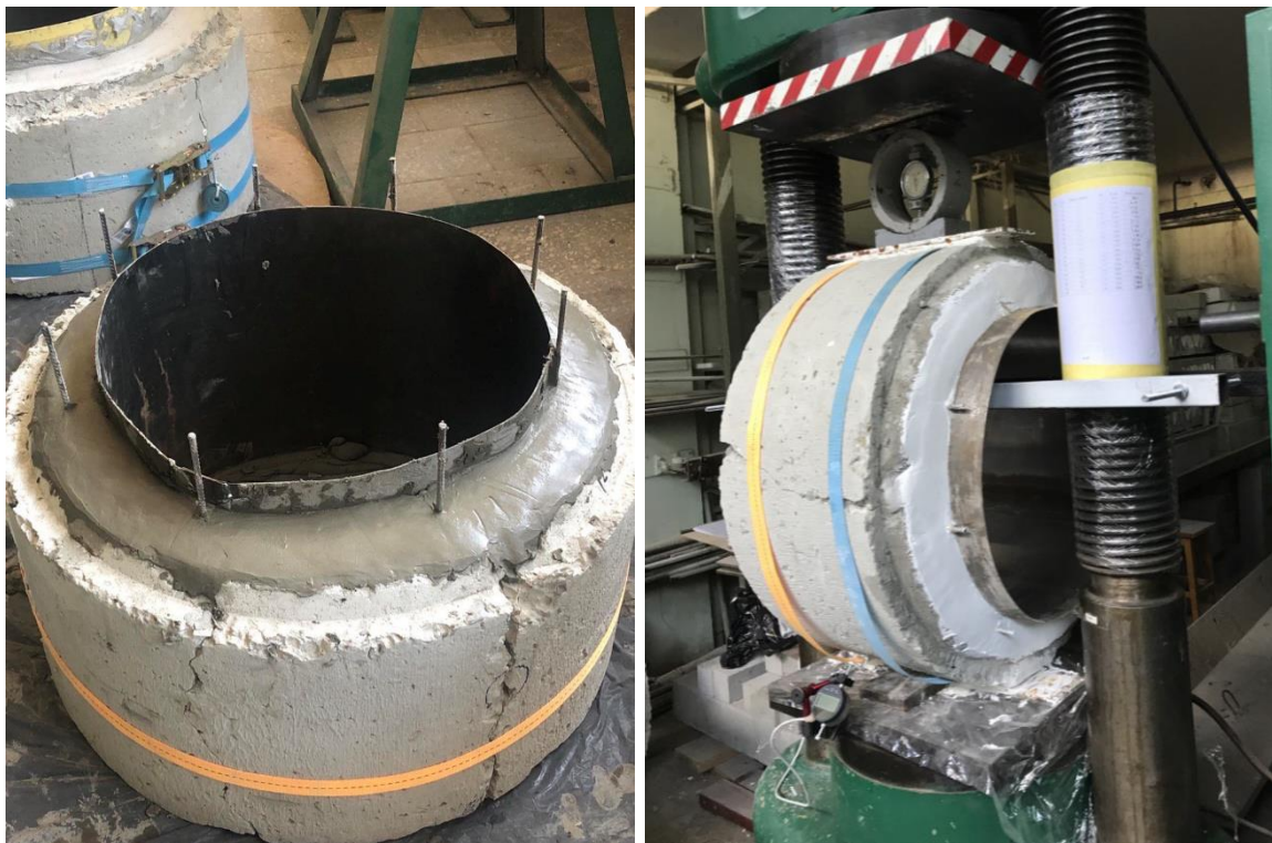
Рис. 4.3. Загальний вигляд дослідних зразків пошкодженої залізобетонної труби підсиленої гільзуванням із використанням арматурного каркасу серії III
