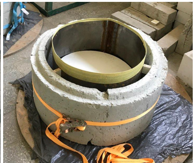
Рис. 4.13. Відцентровані та розклинені металеві труби всередині залізобетонних зразків
