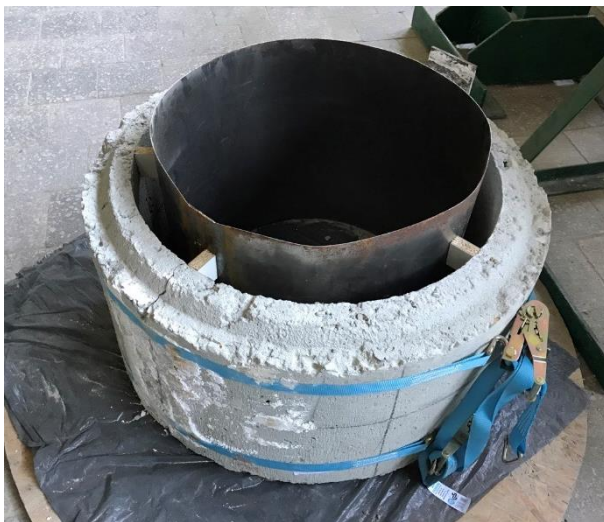
Рис. 4.13. Відцентровані та розклинені металеві труби всередині залізобетонних зразків
