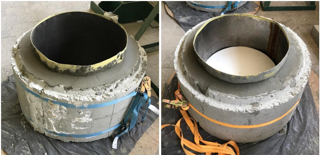
Рис. 4.15. Зразки із заповненим міжтрубним зазором ремонтною сумішшю
