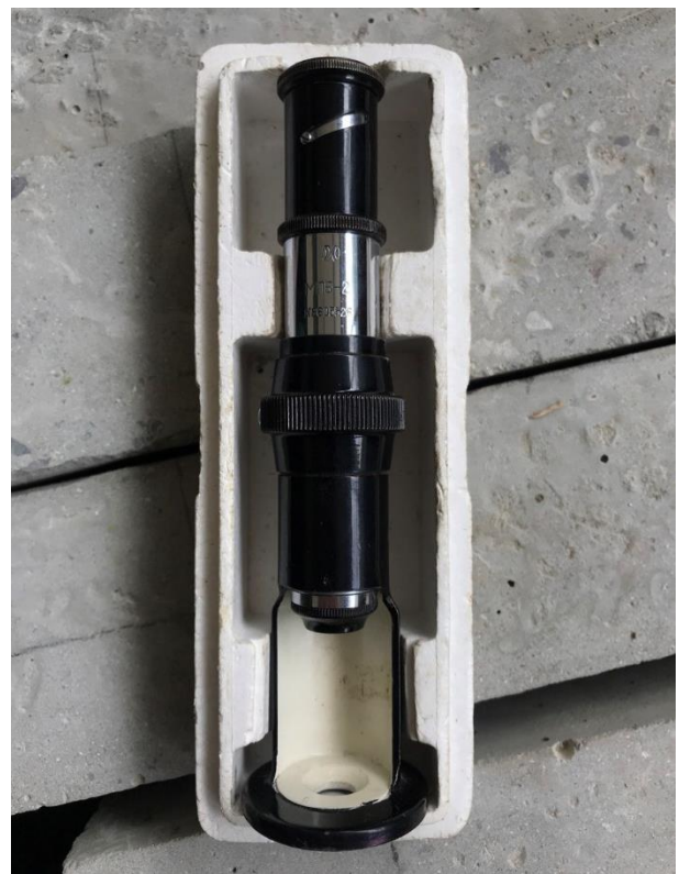
Рис. 4.8. Використане обладнання: а – кільцевий динамометр з індикатором годинникового типу; б – відліковий мікроскоп МПБ-2
