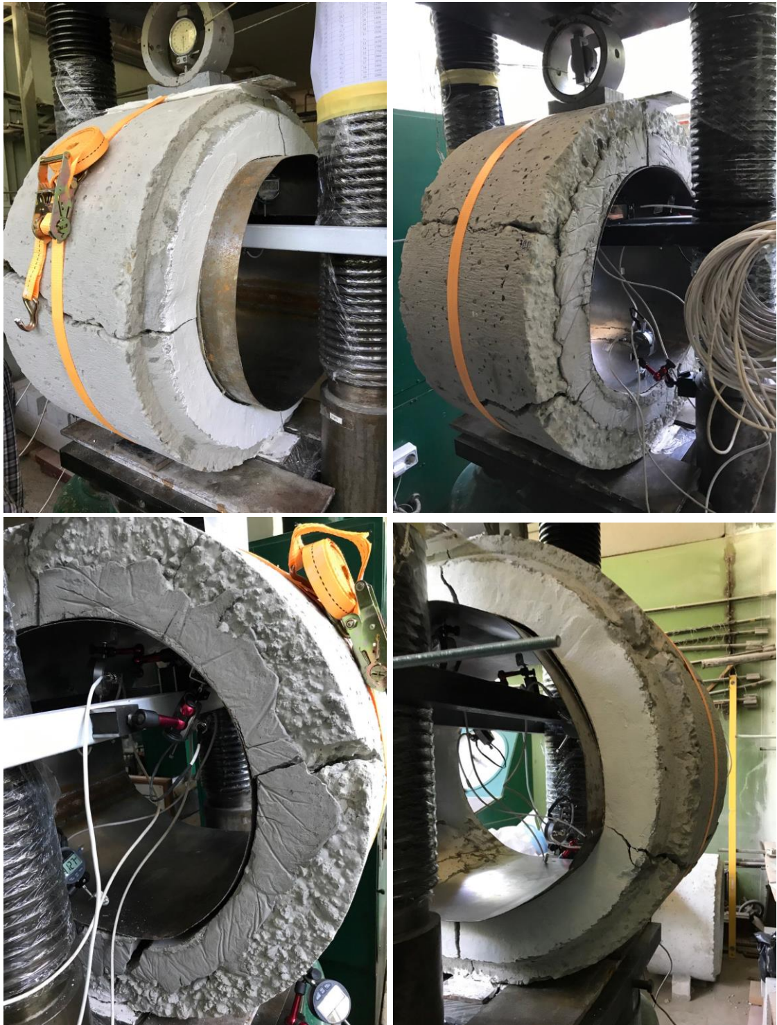
Рис. 4.34. Вигляд зразків серії II після руйнування
