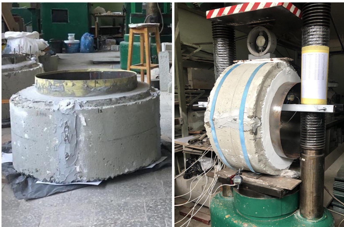
Рис. 4.4. Загальний вигляд дослідних зразків пошкодженої залізобетонної труби, несучу здатність якої відновлено методом ін'єктування епоксидного розчину серії IV
