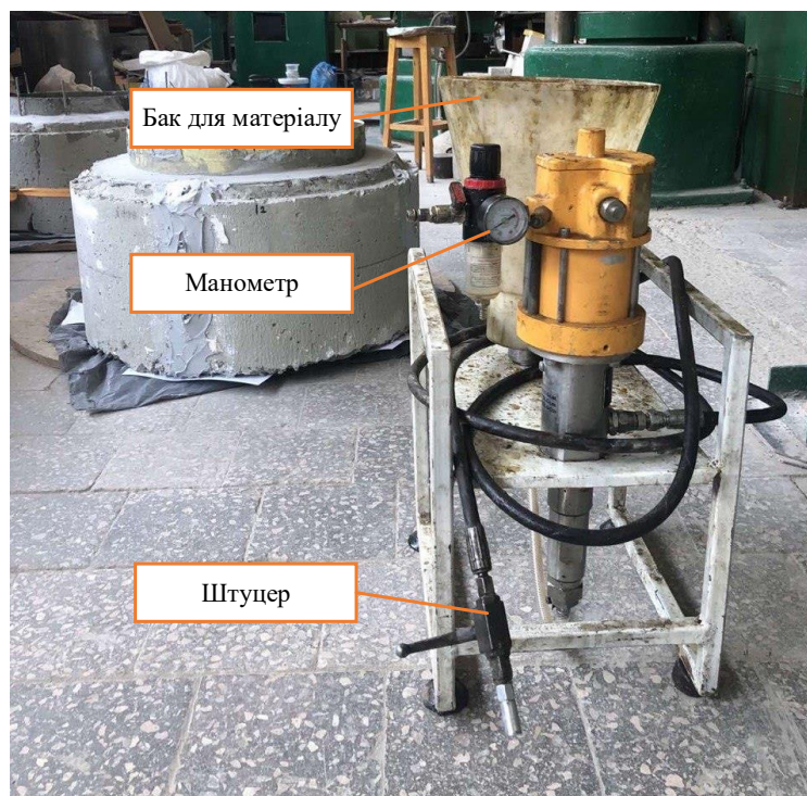
Рис. 4.24. Конструкція поршневого насосу Dittmann Injecta D6
