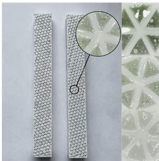
Рис.6.1. Заповнений епоксидним заповнювачем досліджуваний зразок
