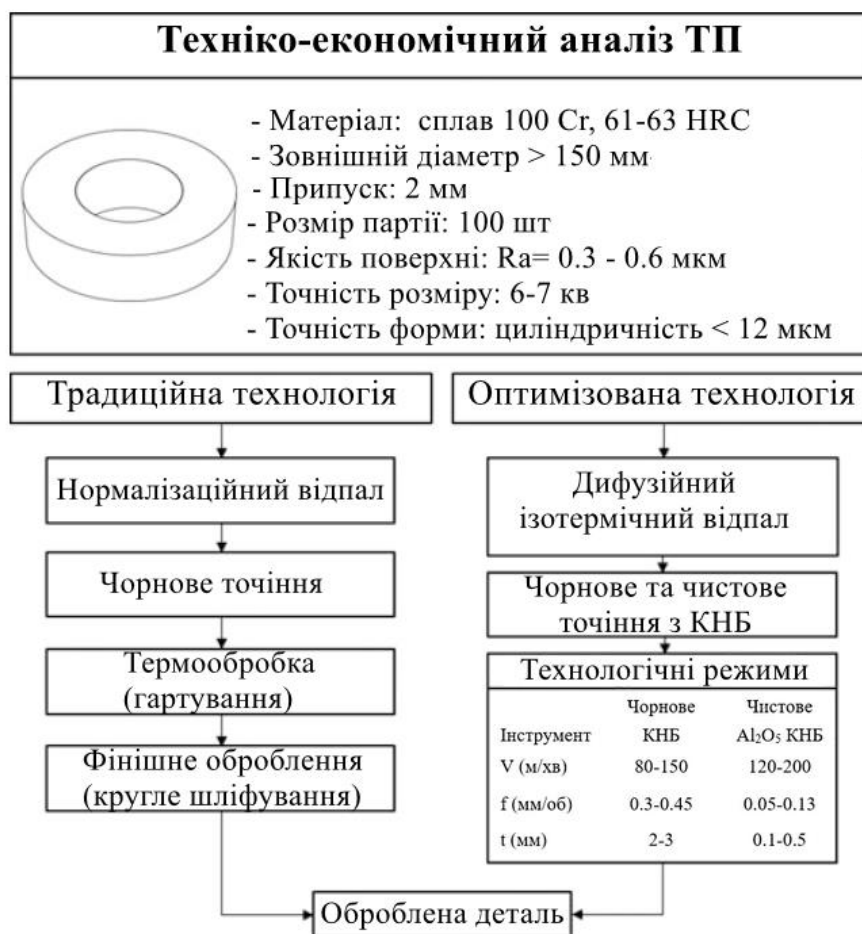
Рис. 1.2. Порівняння традиційної та оптимізованої технології чистової оброблення загартованого сталевго кільця [97]
