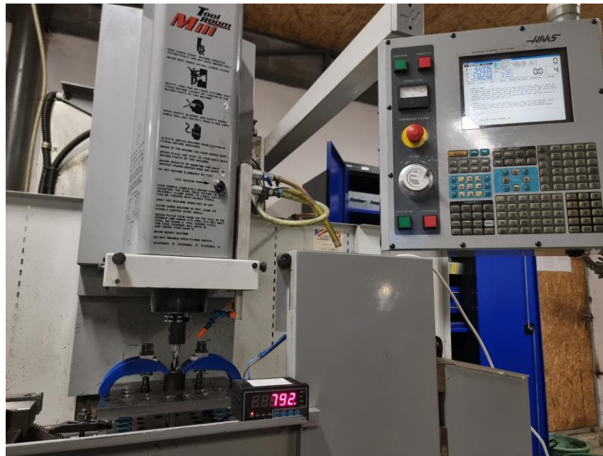
Рис.5.12 Підключення АЦП та калібрування давачів
