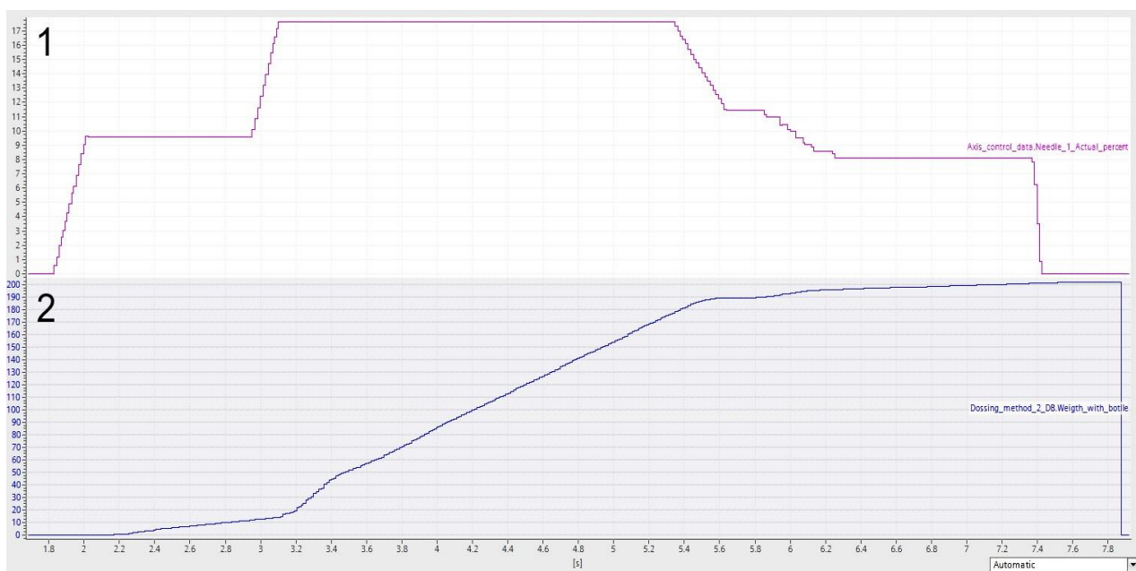
Рис. 3.1.8 Графіки перехідного процесу під час дозування розчину в флакон об'ємом 250 мл: 1 – графік зміни ступеня відкриття перетискного клапана, 2 – графік зміни ваги розчину
