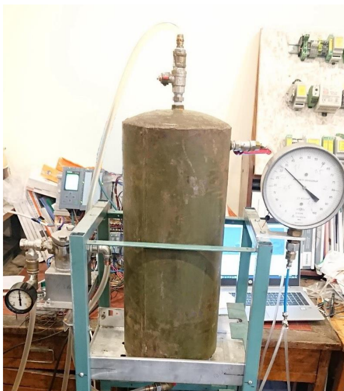
Рис. 2.2.3 Загальний вигляд ємності з інфузійним розчином експериментальної установки для дослідження технологічного процесу дозування інфузійних розчинів
