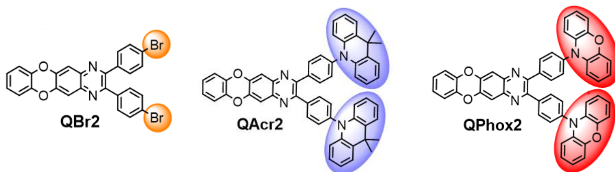
Рис 2.1. Хімічні структури новосинтезованих випромінювачів на основі хіноксаліну.
