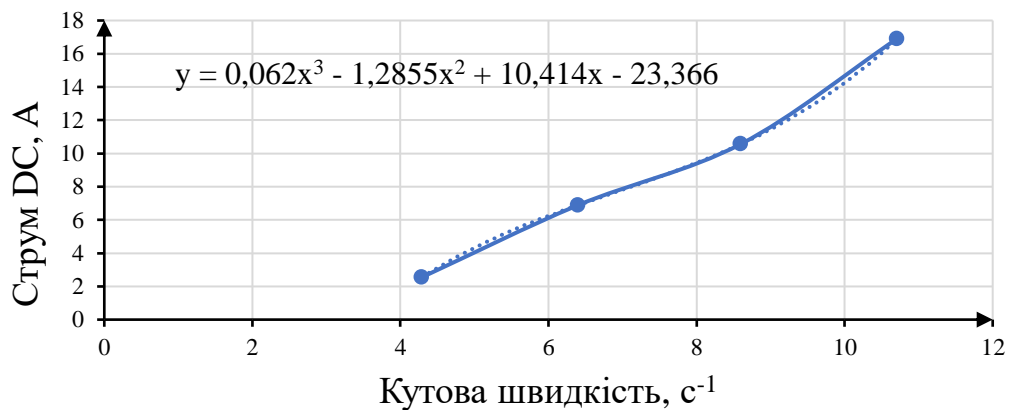
Рис. 3.9. Залежність оптимального випрямленого струму на виході СГПМ від його кутової швидкості
