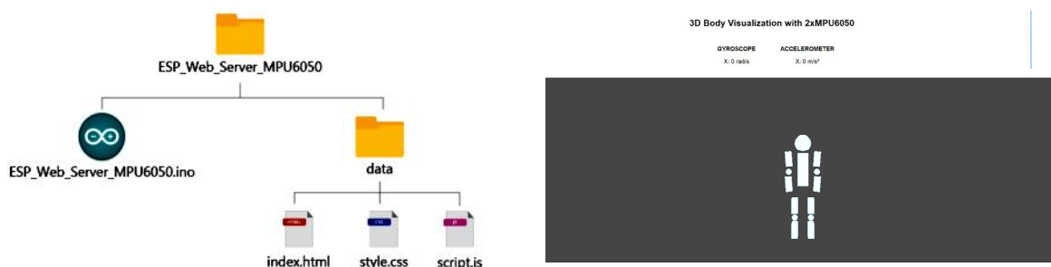
Рис. 3. Структура проєкту веб-сервера ESP32 для моніторингу руху об'єктів з використанням сенсора MPU-6050.
