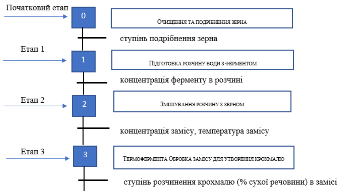
Рис. 2.1. Схема взаємозв'язаних моделей етапів приготування замісу і його ВТО [105]
