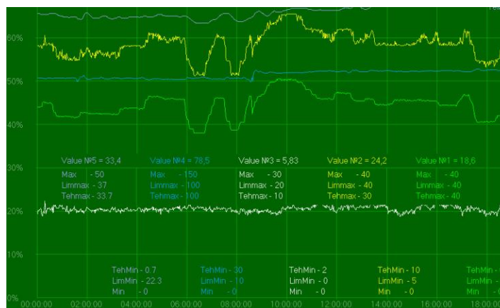
Рис. 4.7. Тестові експерименти: споживання води (зелений колір); гідравлічний модуль (жовтий колір); температура води (синій колір).
