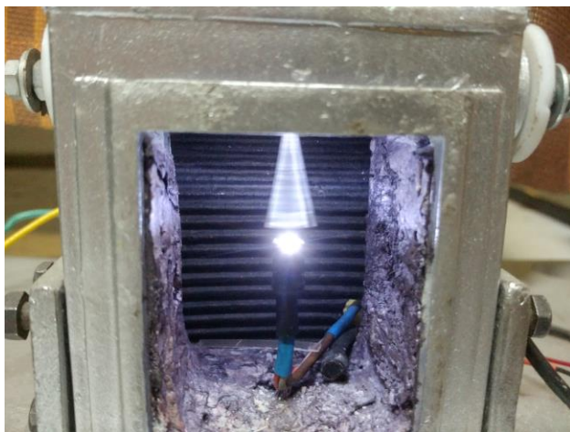
Рисунок 2 – Коливання полімерного зразка у термокамері.
