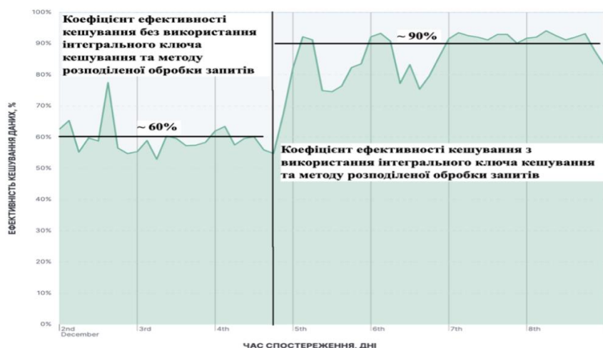
Рис.2.27. Ефективність кешування даних із використанням інтегрального ключа кешування та методу розподіленої обробки запитів
