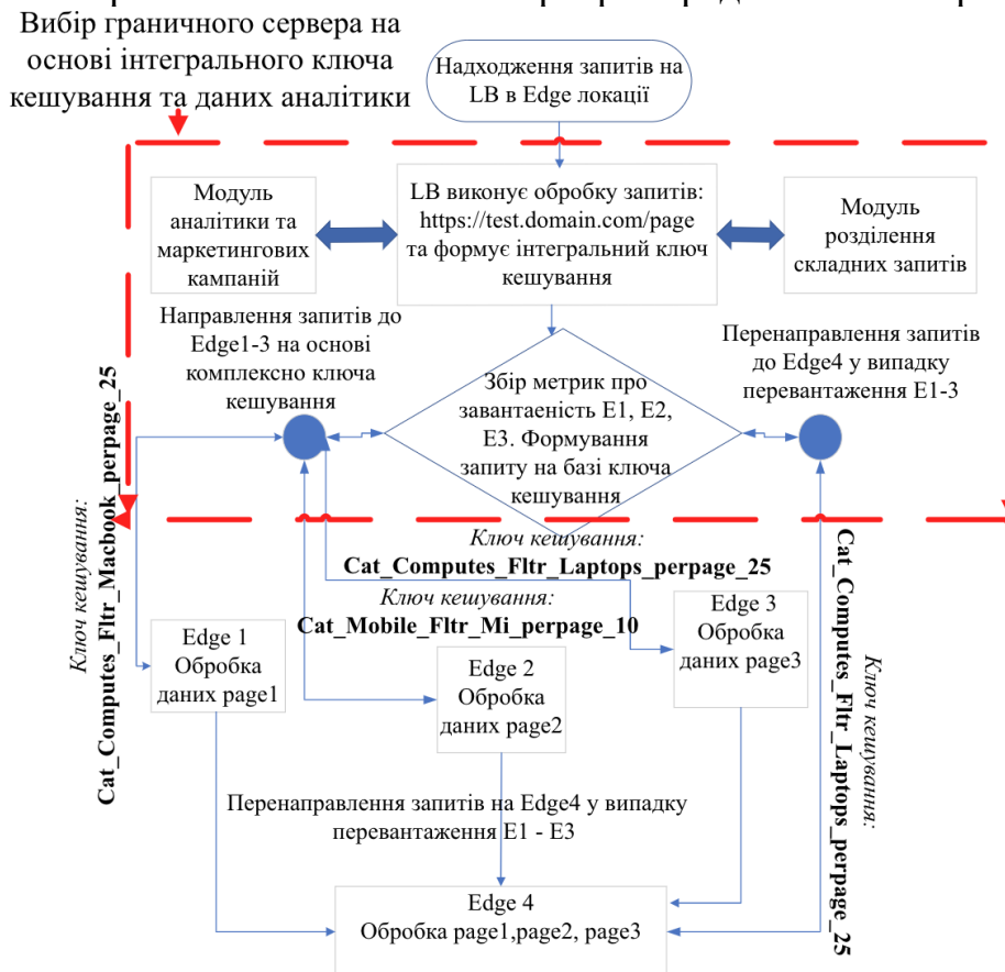
Рис.2. Блок схема алгоритму роботи балансувальника навантаження в граничній локації, який забезпечує максимальну ефективність кешування та контроль завантаженості кешуючих серверів
