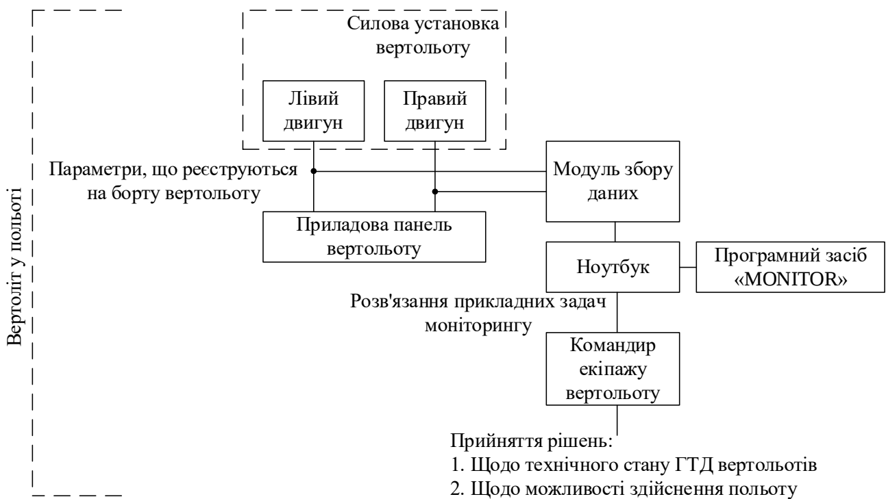
Рисунок 30 – Структурна схема експериментальної установки
