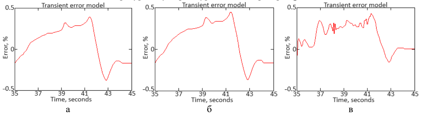
Рисунок 10 – Графіки отриманих похибок перехідних процесів параметрів двигуна ТВЗ-117 на режимі запуску: а) Частота обертів ротора турбокомпресора n_{TC} ; б) Частота обертів ротора вільної турбіни n_{FT} ; в) Температура газу перед турбіною компресора T_G^*
