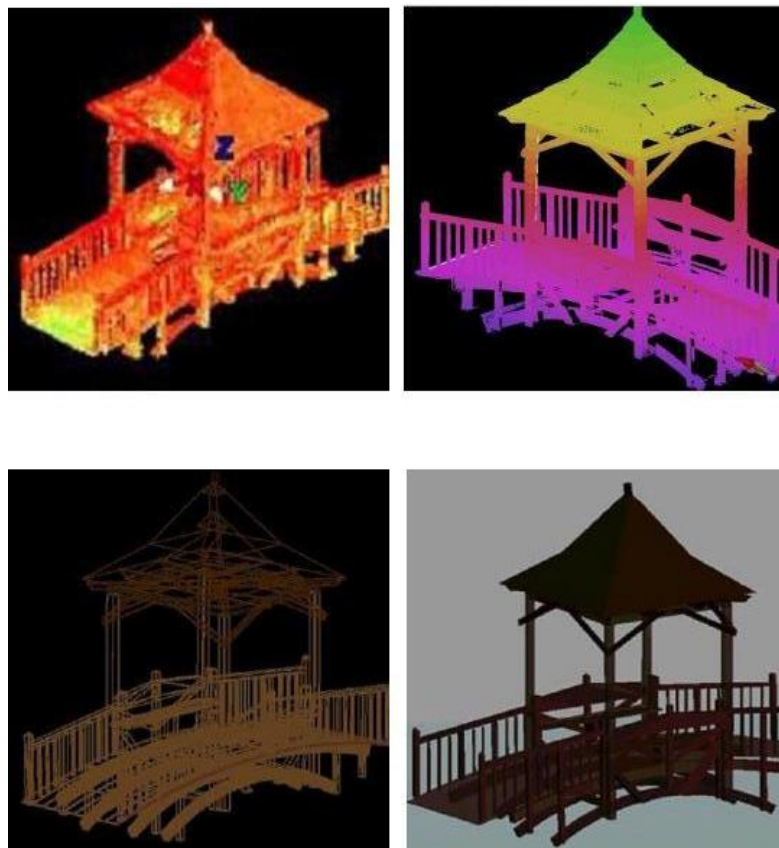
Рис. 3. Метод наземного сканування, паркова альтанка: метод створення тіла з «хмари точок» (вгорі); 3D модель на основі «хмари точок» (внизу) (Рис. А. Бомба, під керівництвом І. Пех)
