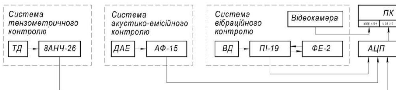
Рис. 3.1. Блок-схема вимірювального комплексу для експериментального дослідження виробів електронної техніки
