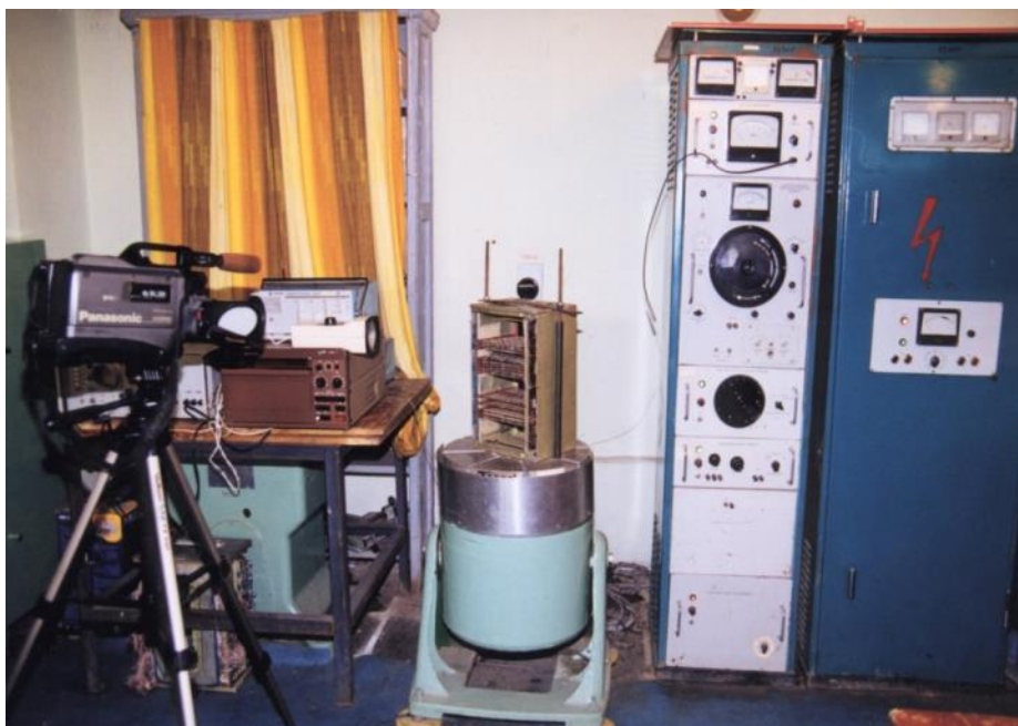
Рис. В.3. Система вібраційного контролю: шафа віброметрична: прилад віброметричний ПІ-19; блок фільтрів електричних ФЕ-2 об'єднані в один пристрій вимірювання прискорення ППУ-1М; вібростенд електродинамічний ВЕДС-200А; відеокамера Panasonic
