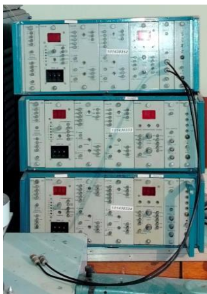
Рис. В.2. Система акустико-емісійного контролю на базі 3-х модифікованих акустико-емісійних приладів АФ-15
