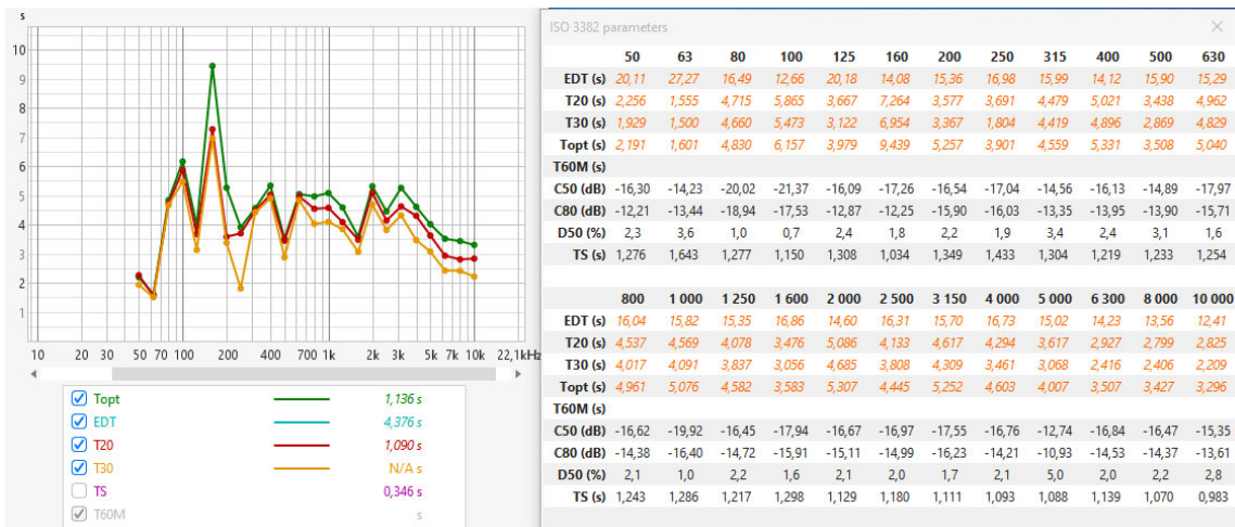
Рис. 21. Результат дослідження відповідно до ДСТУ EN ISO 3382-2:2022 (case #1)
