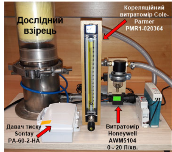
Рис. 23. Фото лабораторного стенду вимірювання опору потоку повітря
