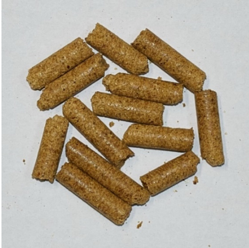
Рис. 27. Дослідні гранульовані зразки твердого палива з кукурудзяної післяспиртової барди
