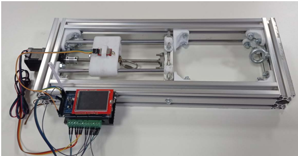
Рис. 1. Установка вимірювання міцності скляної нитки на розрив
