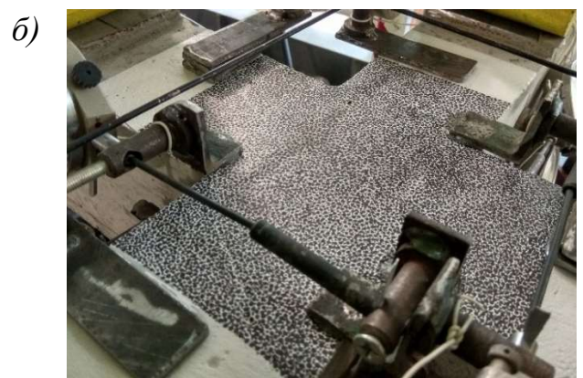
Рис. 2.18. Плямова структура: а – лінійних балок; б – перехресних балок
