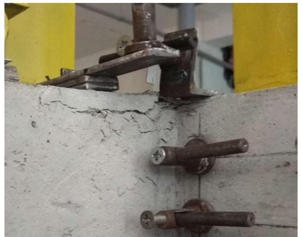
Рис. 3.2. Руйнування стиснутої зони бетону перехресних балок: а – балки ЛП-1; б – балки ЛП-2; в – балки ЛП-3
