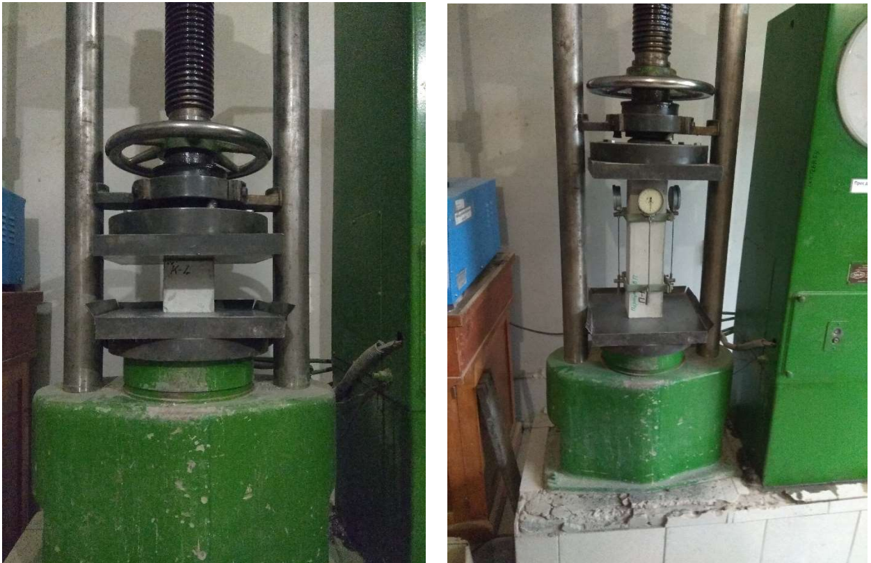
Рис. 2.11. Випробування кубів і призм
