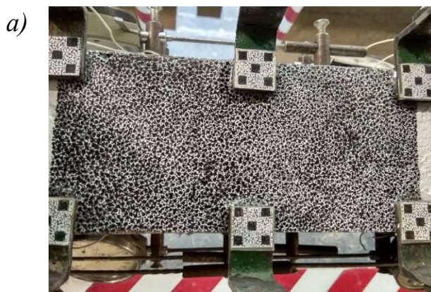
Рис. 2.18. Плямова структура: а – лінійних балок; б – перехресних балок
