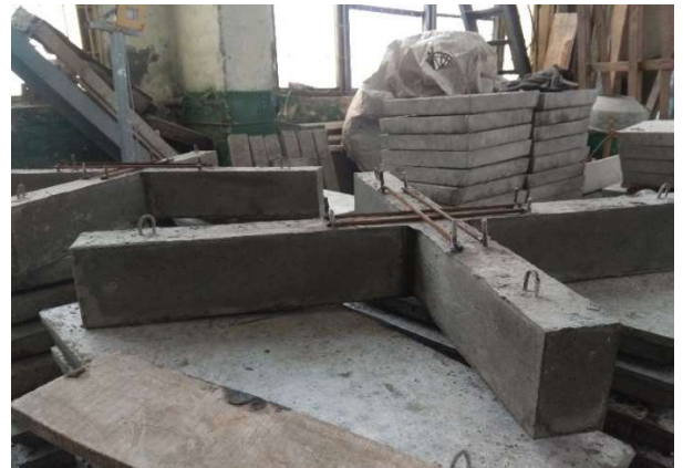
Рис. 2.9. Загальний вигляд дослідних зразків з тимчасовою верхньою зовнішньою арматурою
