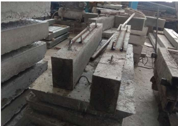
Рис. 2.9. Загальний вигляд дослідних зразків з тимчасовою верхньою зовнішньою арматурою
