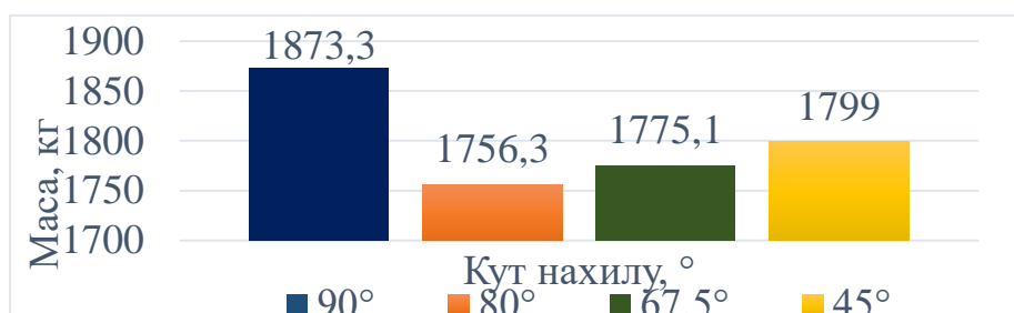
Рис. 2.13. Діаграма впливу кута нахилу стійок \beta на масу комбінованих ферм
