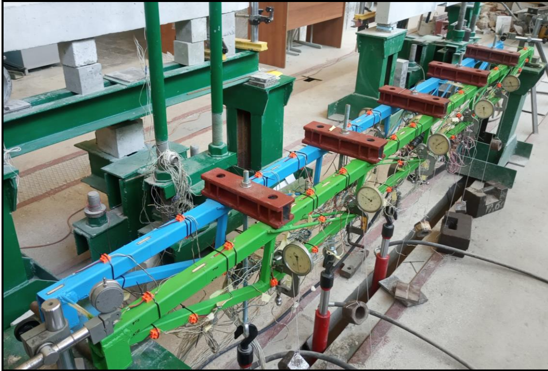
Рис. 4.6. Установка для випробування ферм в натуральну величину (вид зверху)
