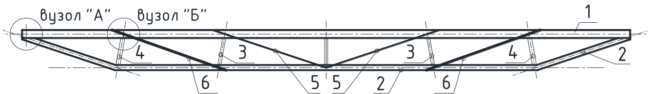
Рис. 4.8. Конструкція зразків раціональних комбінованих ферм з регулюванням ексцентриситетами e_1 - e_2
