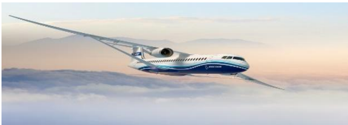
Рис. 2.14. Комбіновані ферми в літакобудуванні: легкі, пружноподатливі, ультратонкі нахилені опори для крил - Boeing і NASA, США
