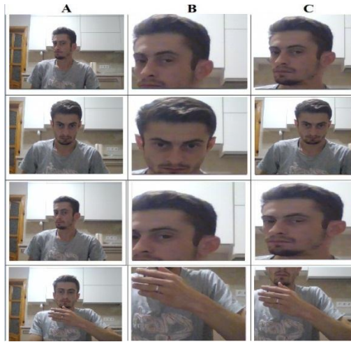
Рис. 3.20. Виявлення та вилучення рухомих об'єктів, стовпець А: вхідний кадр, стовпець: В вилучення рухомих об'єктів за допомогою ViBE, стовпець С: вилучення рухомих об'єктів за допомогою модифікованого ViBE
