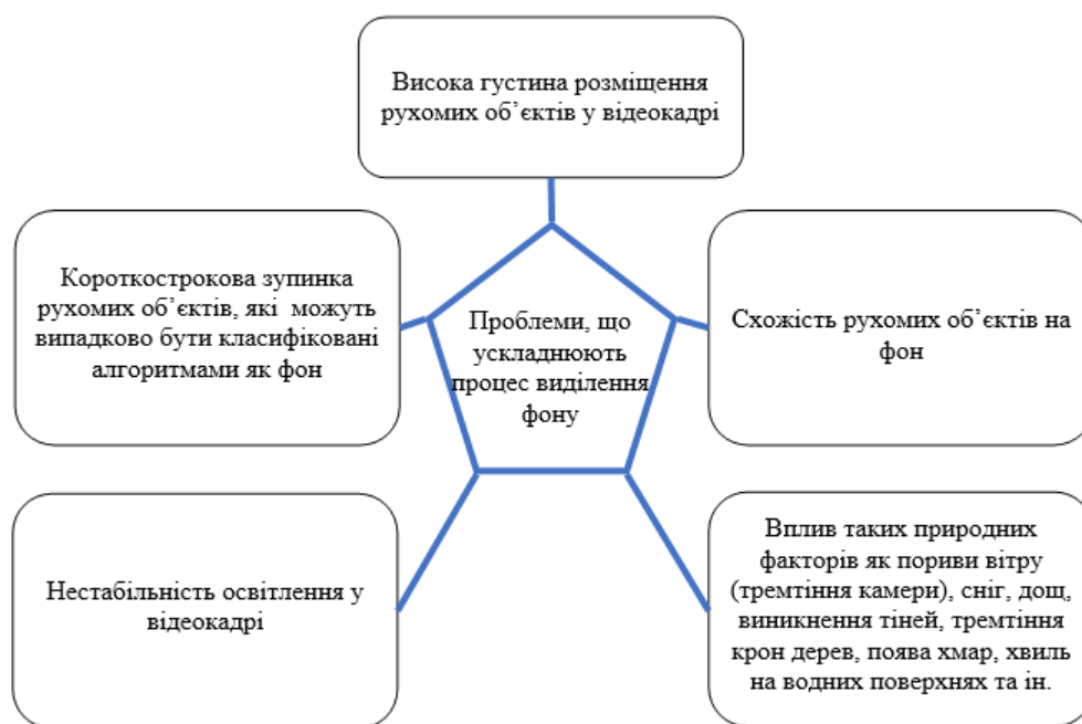
Рис. 1.7. Проблемні фактори, що ускладнюють процес виділення фону
