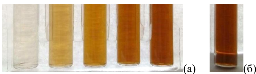
Рис. 3.10. Фотографії одержаного розчину AgNPs за різної тривалості синтезу (5...25 хв) (а) та після 24 годинної експозиції без доступу світла (б)
