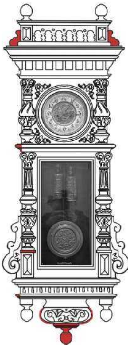
Рис. 3.47. Картограма втрат дерев'яних деталей годинника фірми Gustav Becker. (З реставраційного паспорта твору).
