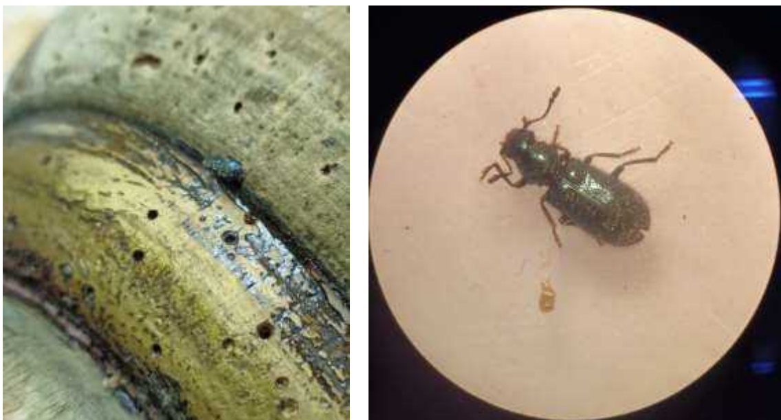
Рис. 2.5. Вусач хатній Hilotrupes bajulus , вражена деталь церковного семисвічника, деревина горіха волоського. (Фото автора).
