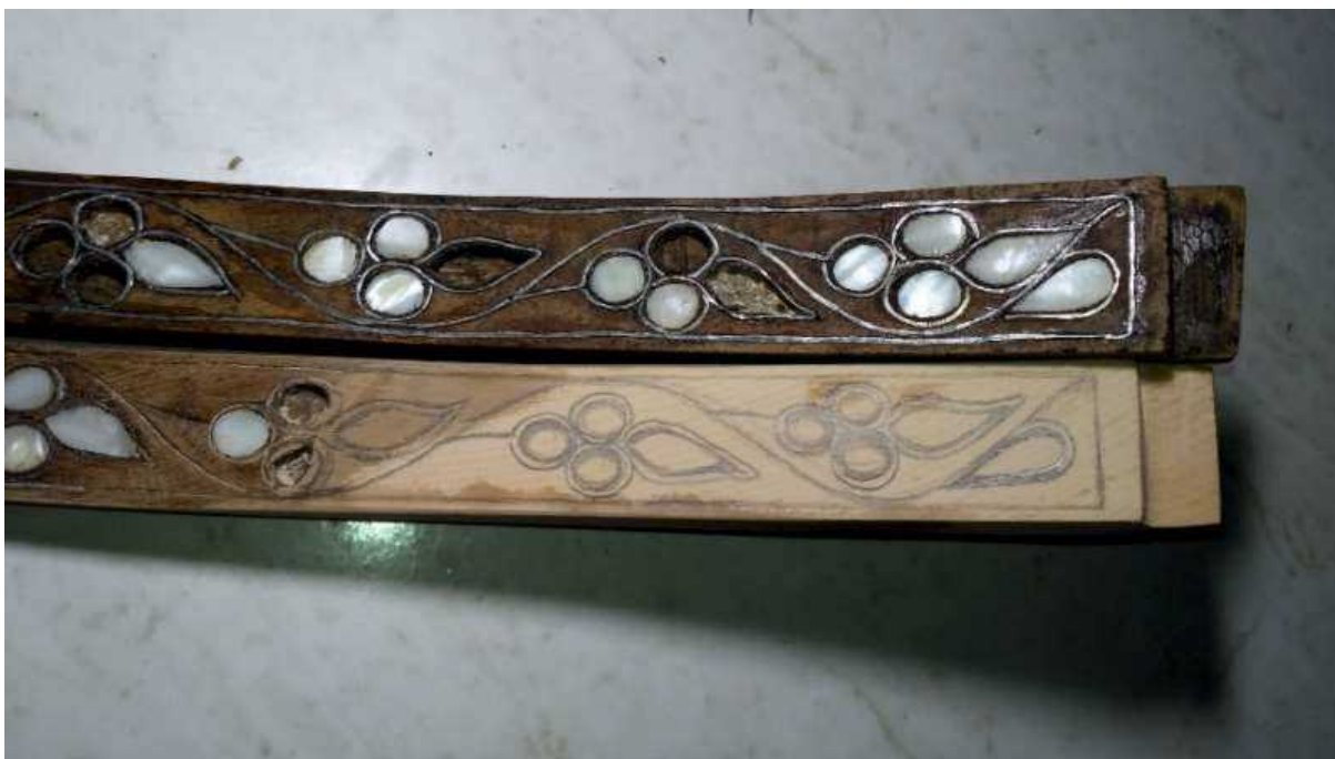
Рис. 3.44. Процес доповнення фрагмента деревини довгої хвилеподібної ніжки стільця в східному стилі. (Фото автора, з реставраційного паспорта).
