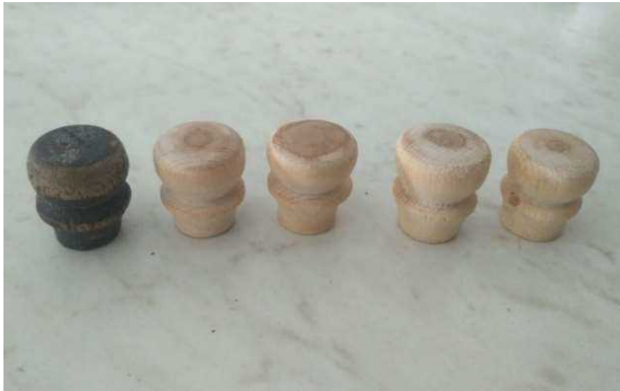
Рис. 3.43. Вигляд оригінального наконечника та реставраційних вставок виготовлених за його зразком. (Фото автора, з реставраційного паспорта твору).
