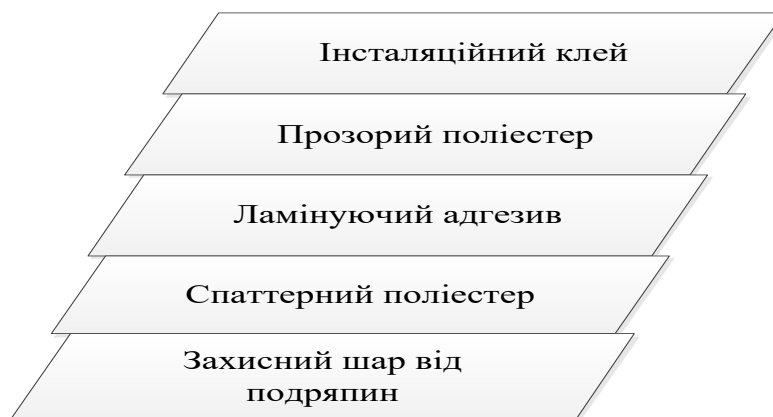
Рис. 2.6. Структура спаттерної плівки
