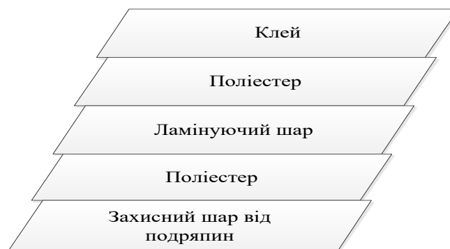
Рис. 3.25. Структура плівки SMC 12
