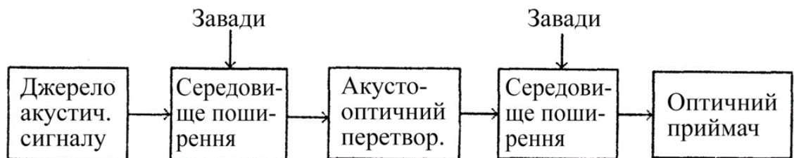
Рис. 4.22. Структура оптоелектронного каналу витоку інформації
