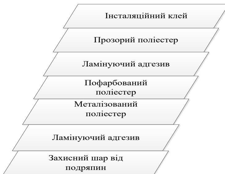
Рис. 2.5. Структура пофарбованої-металізованої плівки
