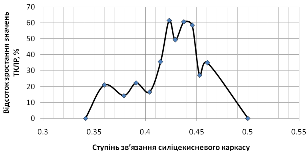
Рис. 4.9. Залежність відсотка зростання значень температурного коефіцієнту лінійного розширення (ТКЛР) в інтервалі склування від ступеня зв'язання силіційкисневого каркаса
