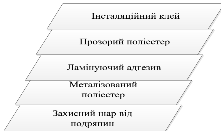
Рис. 2.4. Структура металізованої плівки
