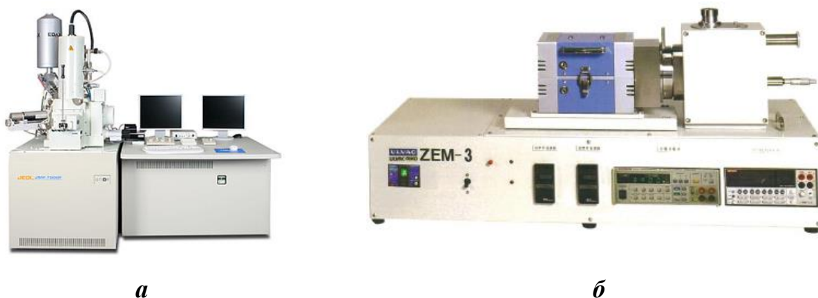
Рис. 2.2. Електронний мікросондовий аналізатор JEOL JSM-5900 (а) та вимірювальний комплекс ZEM-3 (б) (Віденський університет, Австрія)
