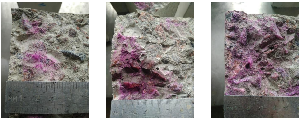
Рисунок 4.31 - Глибина карбонізації бетонів К (а), ПЦТ (б) та ПЦТПв1 (в), які витримували 3 роки у повітряному середовищі
