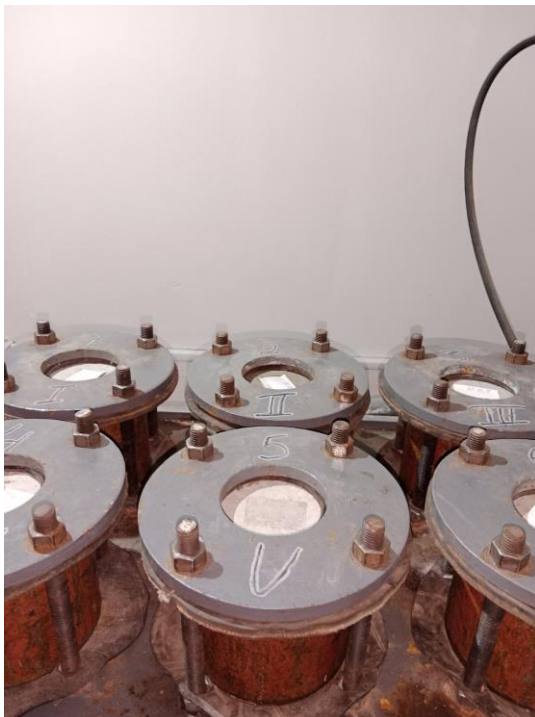
Рисунок 6.14 – Випробування бетону на водонепроникність
