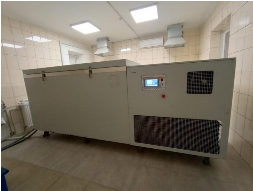
Рисунок 6.15 – Випробування бетону на морозостійкість
