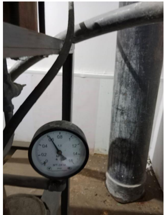
Рисунок 6.14 – Випробування бетону на водонепроникність
