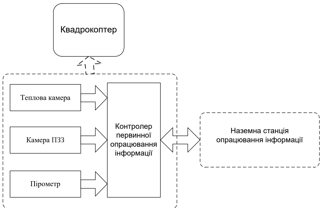
Рис.3.1. Структура системи тепловізійного моніторингу тепловтрат зовнішніх огорожувальних конструкцій будинку.
