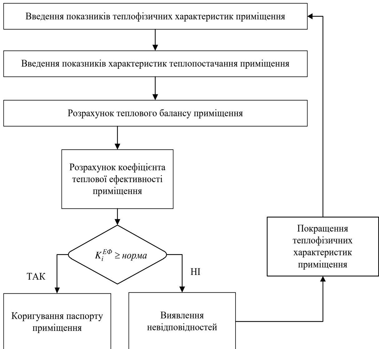
Рис. 2.6 Алгоритм вимірювання теплового балансу окремого приміщення в багатоквартирному будинку.
