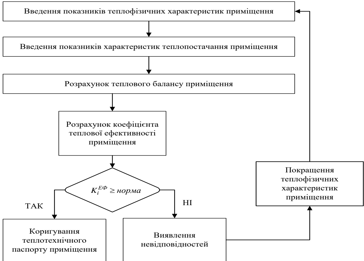
Рис. 3 Алгоритм визначення коефіцієнта теплової ефективності окремого приміщення в багатоквартирному будинку.
