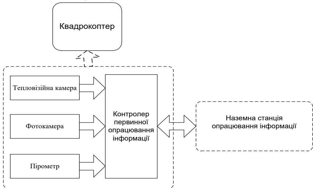
Рис.5. Структура системи тепловізійного моніторингу тепловтрат зовнішніх огорожувальних конструкцій будинку.
