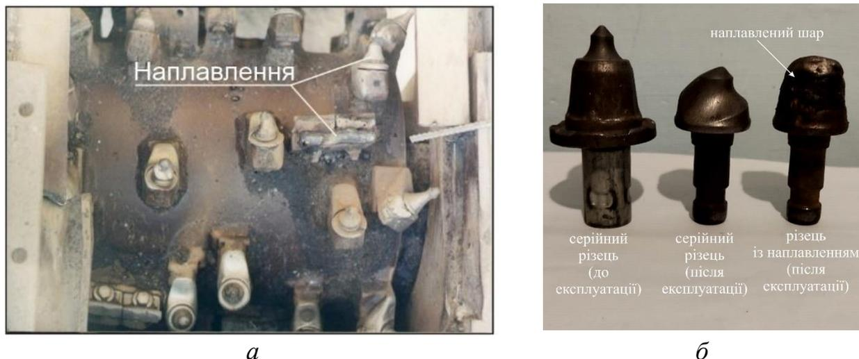
Рисунок 7.10 – Загальний вигляд дорожньої фрези (а) та різців до та після промислових випробувань (б)
