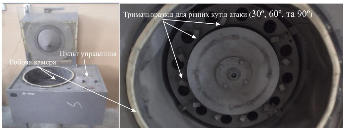
Рисунок 2.15 – Загальний вигляд відцентрового прискорювача Клейса для випробувань за умов аероабразивної ерозії
