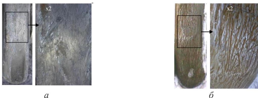
Рисунок 1.12 – Знос верхньої (*а*) та нижньої (*б*) поверхонь зуба екскаватора при роботі у середовищі граніту [113]
