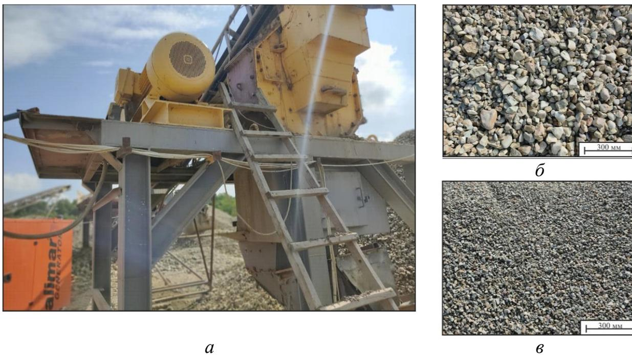
Рисунок 7.2 – Загальний вигляд *PULVOMATIC* 1145 (а), вихідної сировини (б) та готової продукції (в)
