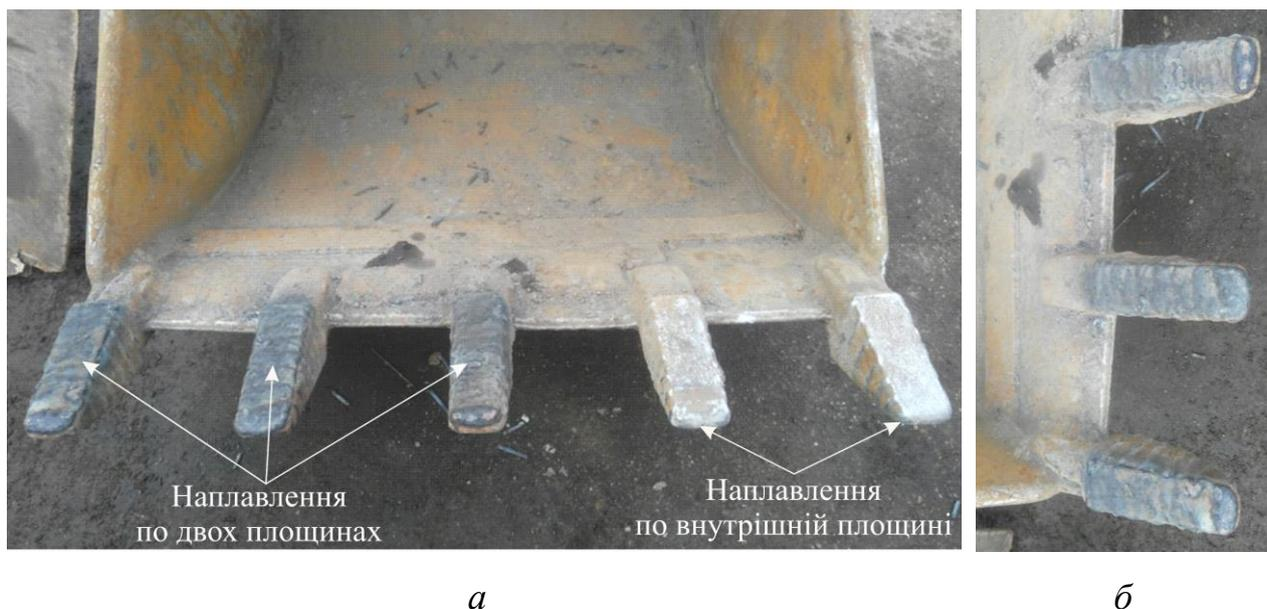
Рисунок 7.13 – Загальний вигляд відновлених зубів екскаватора *JCB* шляхом наплавлення за різними схемами сплавом 70M24Г13P3
