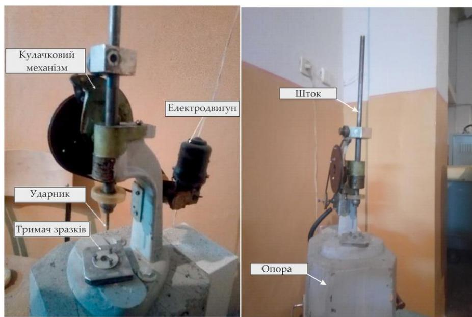
Рисунок 2.13 – Стенд для визначення зносотривкості за умов ударно-абразивного зношування
