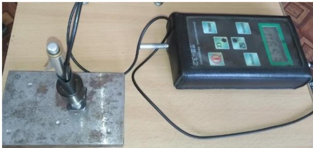
Рисунок 2.9 – Загальний вигляд процесу вимірювання твердості із використанням динамічного твердоміру ТД-32
