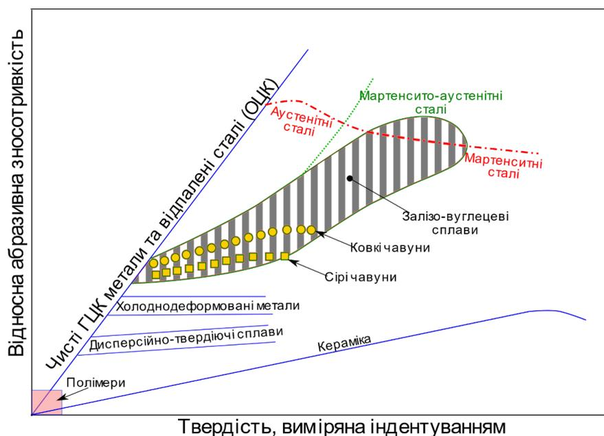
Рисунок 2.10 – Взаємозв'язок між твердістю та абразивною зносотривкістю для ряду конструкційних матеріалів за даними [164]
