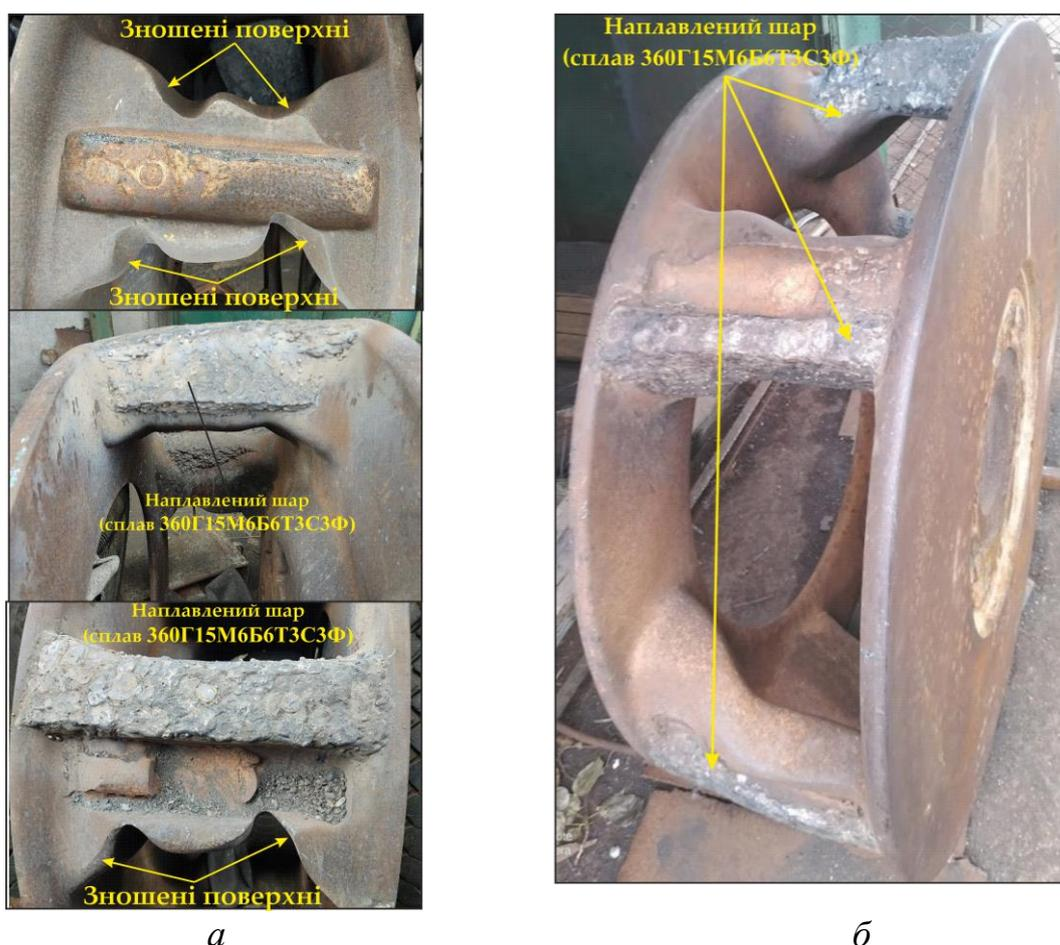
Рисунок 7.4 – Зношені та реставровані секції ротора дробарки *PULVOMATIC* 1145 (а) та загальний вигляд ротора після відновлення геометрії зношених поверхонь (б)
