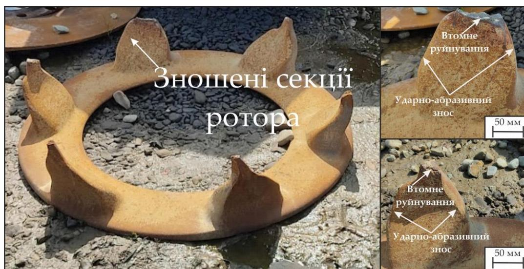
Рисунок 7.3 – Характер катастрофічного зносу ротора дробарки *PULVOMATIC* 1145
