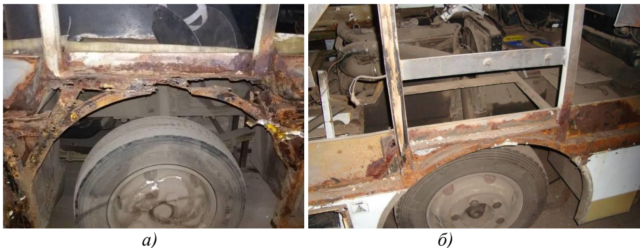
Рис. 14. Корозія правої боковини автобусів «Богдан» А092 біля переднього колеса: а) – термін експлуатації десять років; б) – термін експлуатації п'ять років
