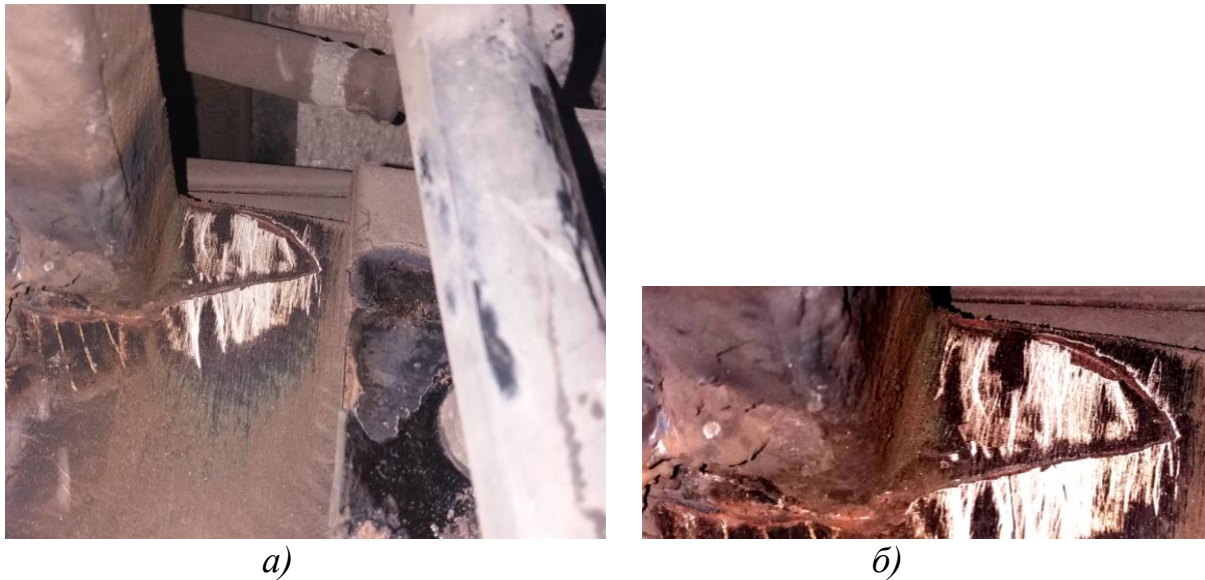
Рис. 7. Місце руйнування з'єднання каркасу основи з правою боковиною під дією магістральної втомної тріщини та корозії: а) загальний вигляд; б) місце тріщини (збільшено)
