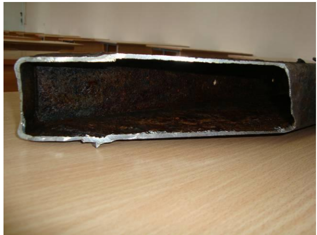
Рис. 18. Зовнішня та внутрішня корозія лонжеронів каркасу основи профілем 140×60×3 мм автобуса «Богдан» А092 в районі задніх арок: а) – зовнішня корозія фрагменту лонжерона; б) – розріз, що показує зменшення товщини стінок лонжерона
