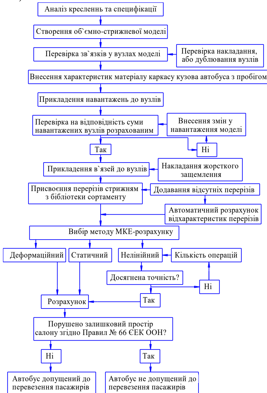
Рис. 10. Блок-схема алгоритму проведення розрахунків міцності кузова автобуса під час експлуатації на відповідність вимогам Правил ЄЕК ООН № 66
