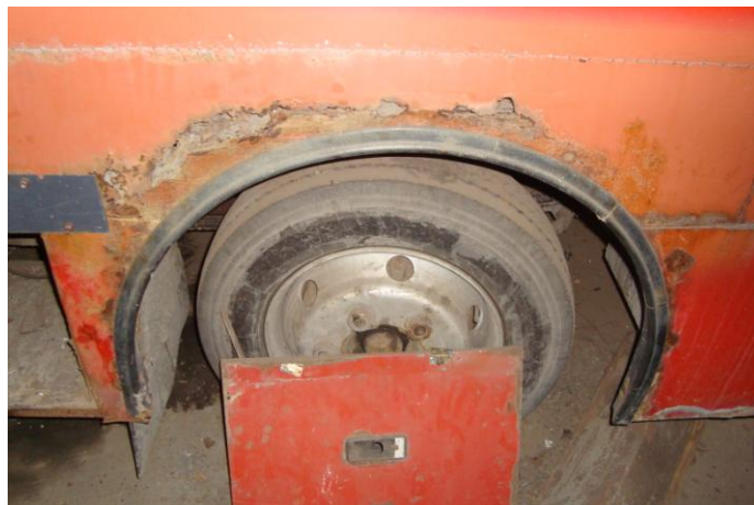
Рис. 19. Корозія облицювання автобуса «Богдан» А092 після дев'яти років експлуатації
