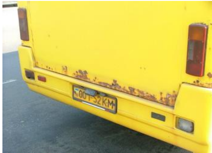
Рис. 20. Корозія панелі автобуса «Еталон» над заднім бампером
