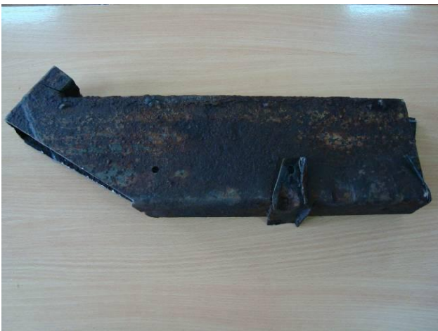
Рис. 18. Зовнішня та внутрішня корозія лонжеронів каркасу основи профілем 140×60×3 мм автобуса «Богдан» А092 в районі задніх арок: а) – зовнішня корозія фрагменту лонжерона; б) – розріз, що показує зменшення товщини стінок лонжерона
