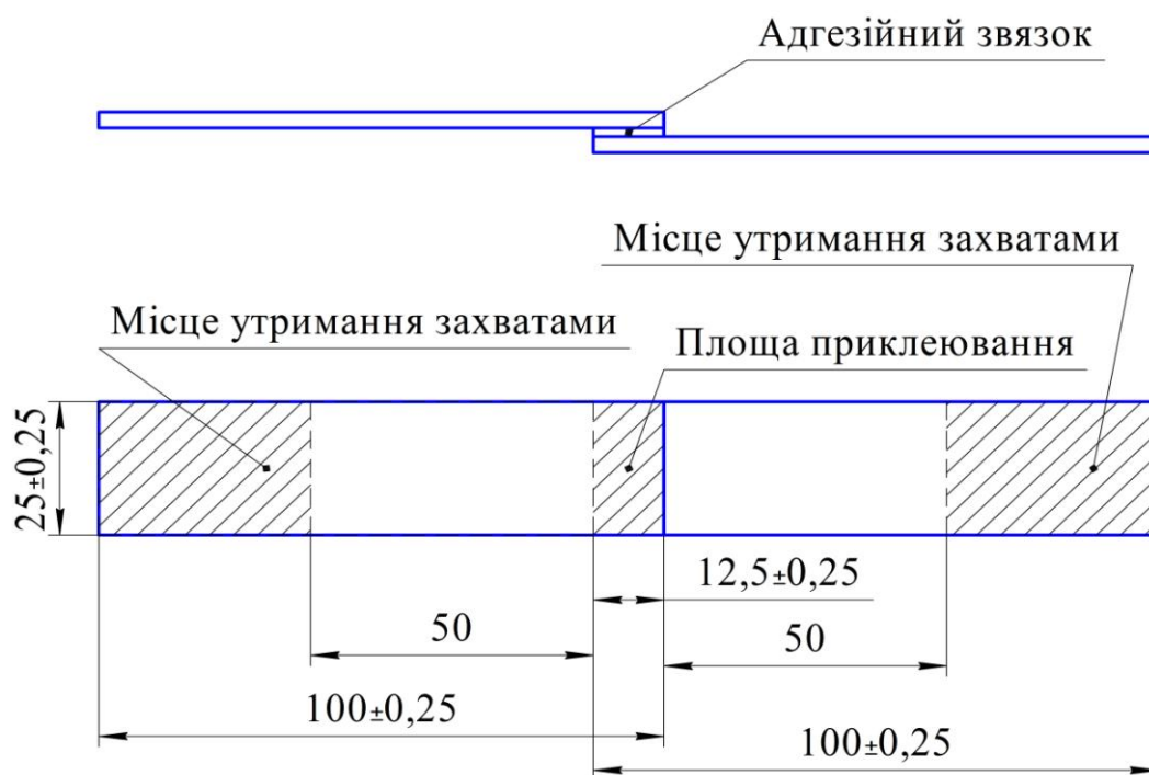
Рис. 15. Форма і розміри тестових зразків, що використовувались під час досліджень
