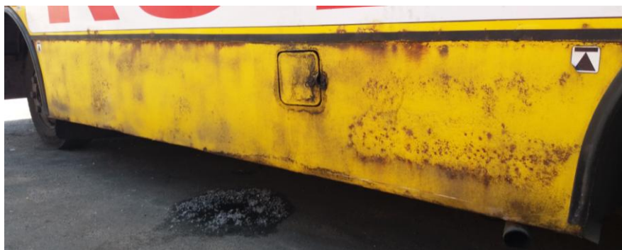
Рис. 16. Корозія бічних поверхонь автобуса «Богдан» А092
