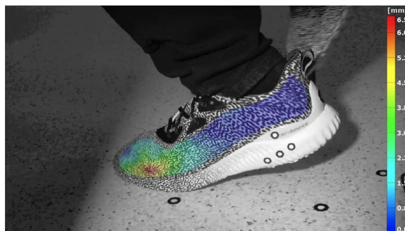
Рис.1.5. Дослідження поведінки взуття під час бігового навантаження за допомогою КЦЗ [60].
