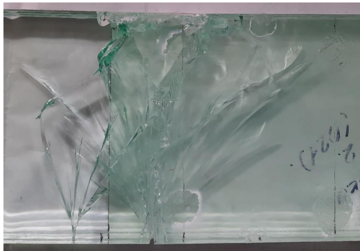
Рис. 3.28. Руйнування балок серії 2: а) Вм-2.3.1, б) Вм-2.3.2.
