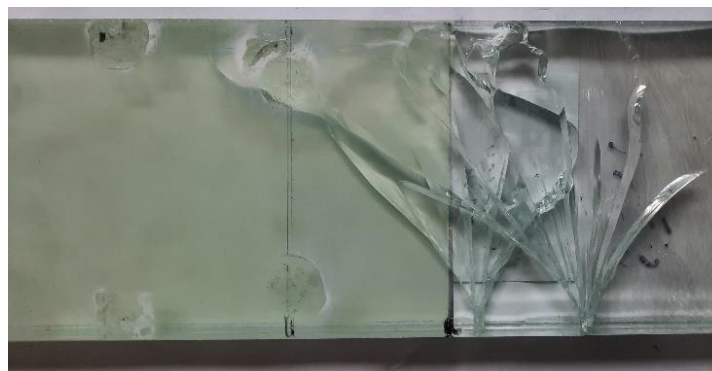
Рис. 3.15. Руйнування балок серії 1: а) Вm-1.2.3, б) Вm-1.2.4.
