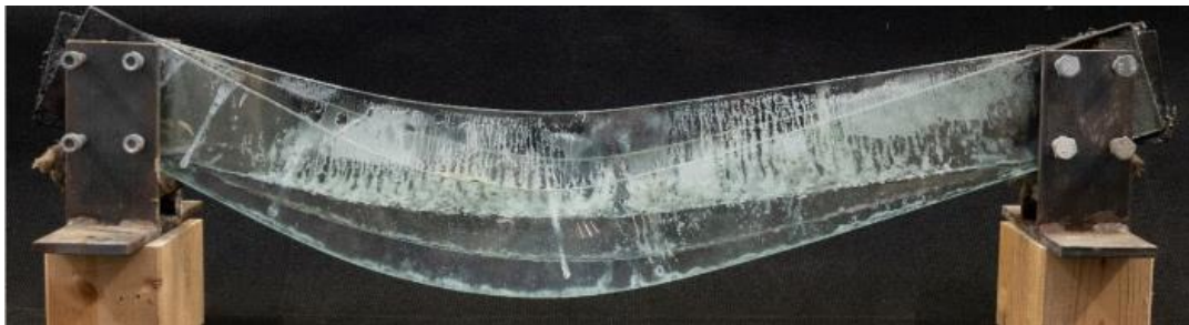
Рис.1.15. Дослідження скляних балок при пожежі [125].
