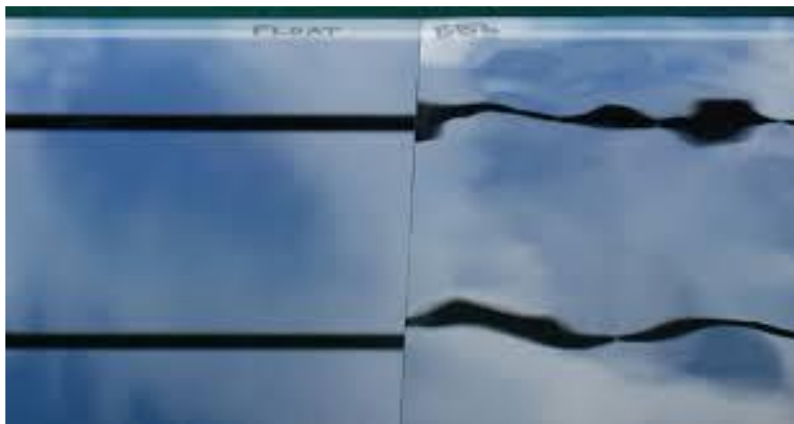
Рис.1.3. Порівняння флоат скла та скла, яке виготовлене технологією розкатування [17].
