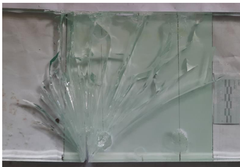
Рис. 3.35. Руйнування балок серії 3: а) Vm-3.2.1, б) Vm-3.2.2.
