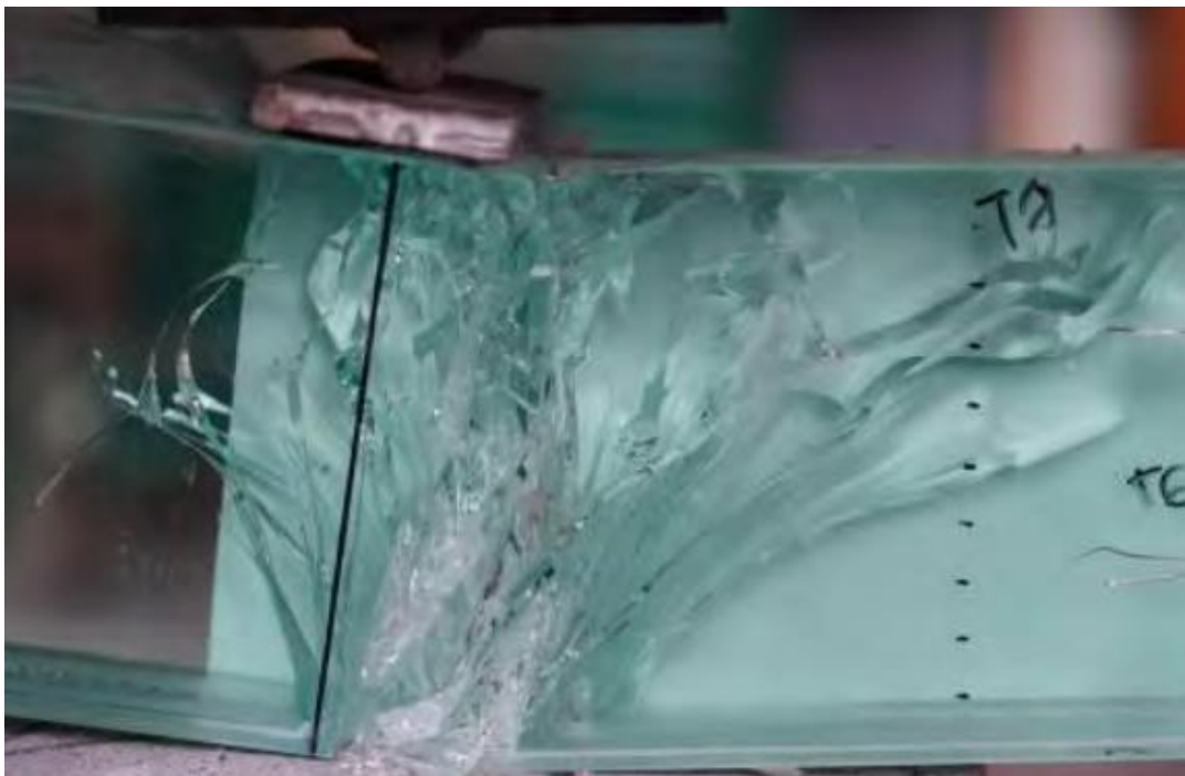
Рис.1.13. Характер руйнування скляних балок у дослідженнях [106].
