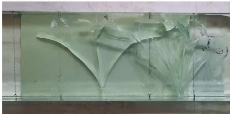
Рис. 3.18. Руйнування балок серії 1: а) Vm-1.3.1, б) Vm-1.3.2.
