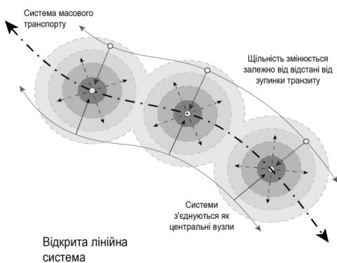
Рис. 3. Теорія «компактного сталого міста» Р.Роджерса (Towards end urban renaissance, 1999), що функціонує на базі об'єднання громадським транспортом. Компактні багатofункціональні вузли зменшують потреби в поїздках.
