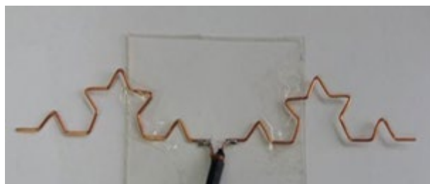
Рис. 1.6. Приклад застосування кривої Коха у фрактальній антені
