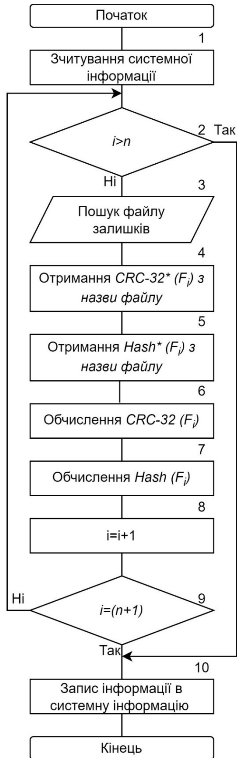
Рисунок 4.4 – Алгоритм зчитування файлів залишків та обчислення геш-функції
