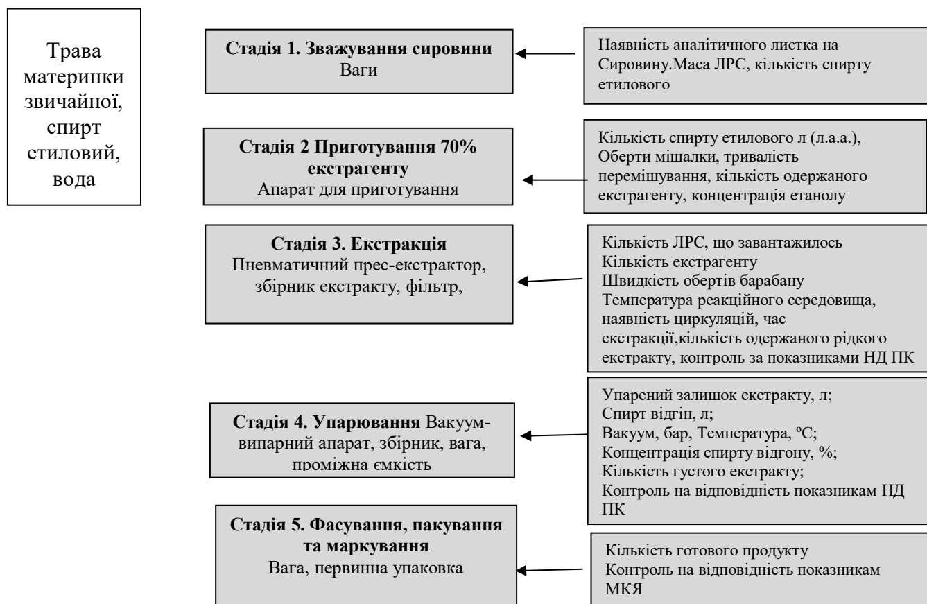
Рис. 3.5.3 Блок-схема технологічного процесу отримання Материнки трави екстракту густого
