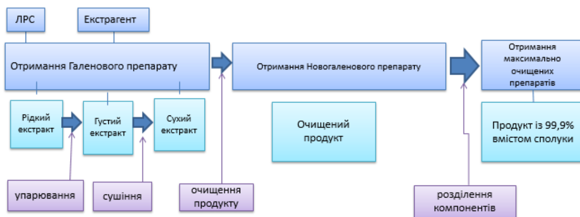
Рисунок 1.1 Схема отримання АФІ із ЛРС
