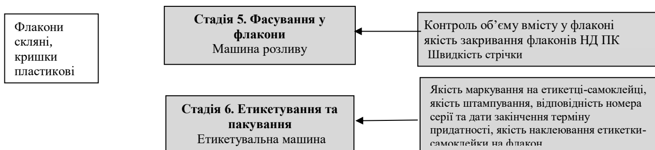
Рис. 5.2.1 Блок-схема технологічного процесу отримання сиропу
