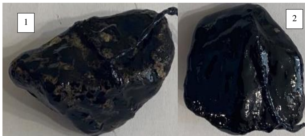
Рис.5.1. Адгезія до щебеню: 1 – БД 100/150 (2 бали), 2 – БМВ 60/90 (5 балів).
