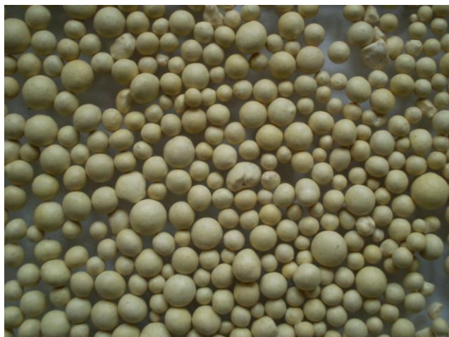
Рисунок 5.8 - Зовнішній вигляд капсульованої гранульованої нітроамофоски оболонкою полістирол-лігнін
